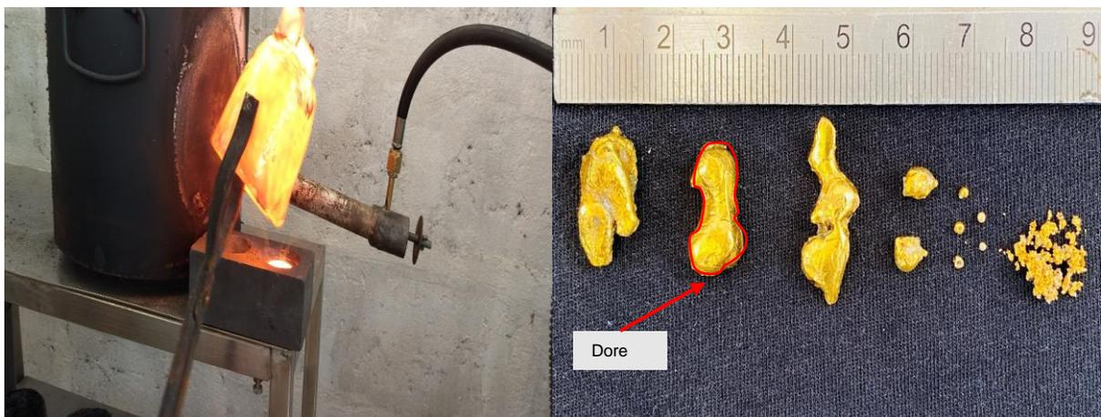
**Figura 51.** Obtención del dore por medio de la Fundición.
