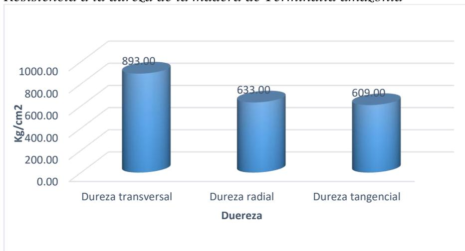
**Nota.** Valores de la dureza de la madera kg= kilogramo, cm<sup>2</sup>= centímetros cuadrados.
