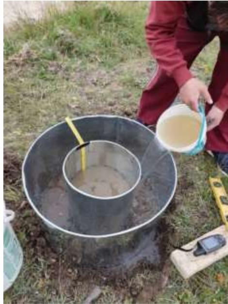
*Nota.* Imagen referencial a los ensayos de infiltración
