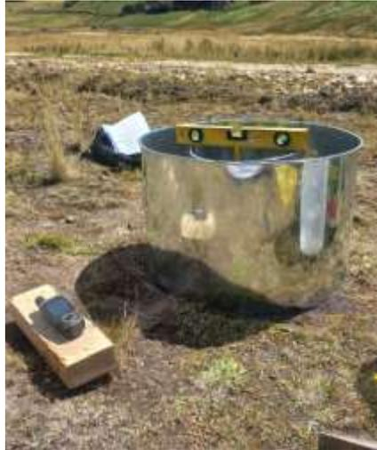
*Nota.* Para una correcta medición de las alturas del agua se utiliza un nivel para que la anilla esté correctamente instalada
