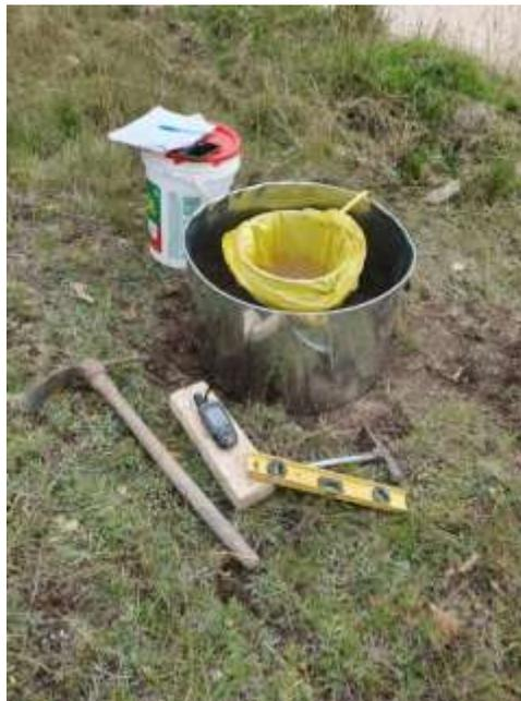
*Nota.* Preparación y colocación de los instrumentos para inicio de ensayos de infiltración
