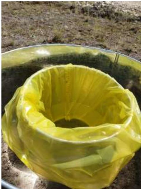
*Nota.* Preparación de los anillos antes del vaciado del agua, esto para que, al quitarlos, la distribución del agua se uniforme y no erosione el suelo
