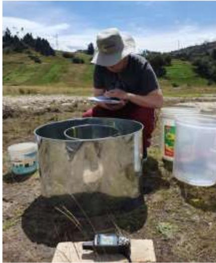
*Nota.* Se muestra la medición de los desniveles según los intervalos de tiempos determinados
