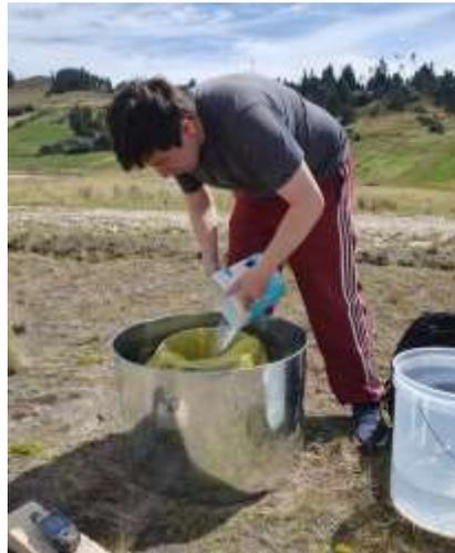
*Nota.* Cuando el agua va infiltrando entre los intervalos fijados, se adiciona agua y se anota el nuevo nivel alcanzado
