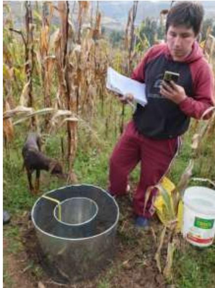
*Nota.* Utilización de cronómetro para control de tiempos en el ensayo de infiltración.
