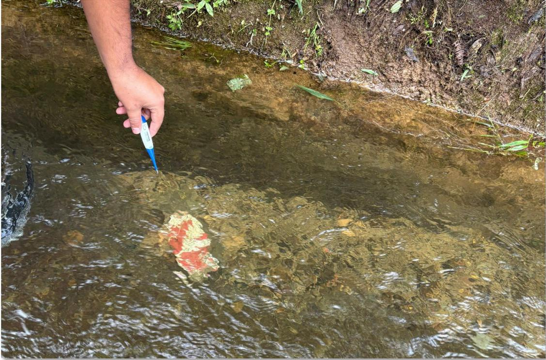
**Fotografía 08: Ensayo de evaporación en la captación del canal Perlamayo.**
