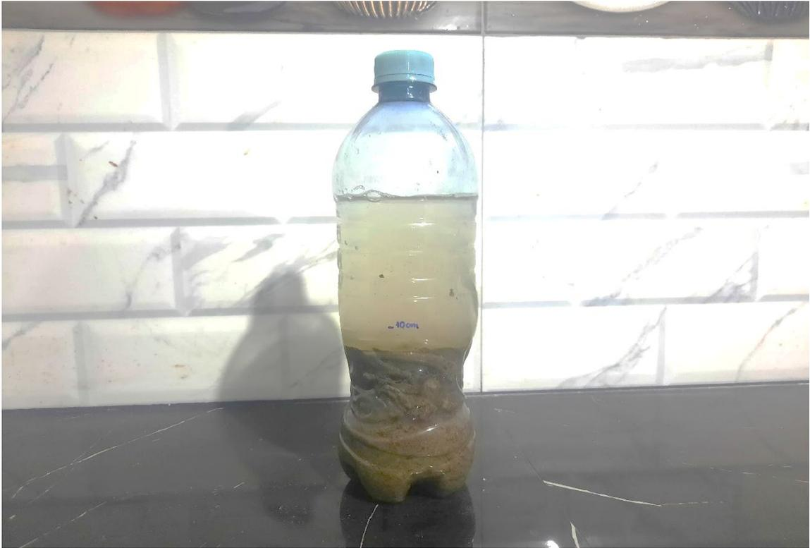
**Fotografía 44:** Prueba de la botella, después de 12 horas (suelo arcilloso - arenoso).
