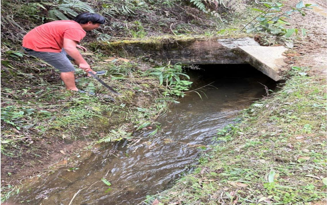
**Fotografía 10:** *Tubo de Pitot para la determinación de caudales.*
