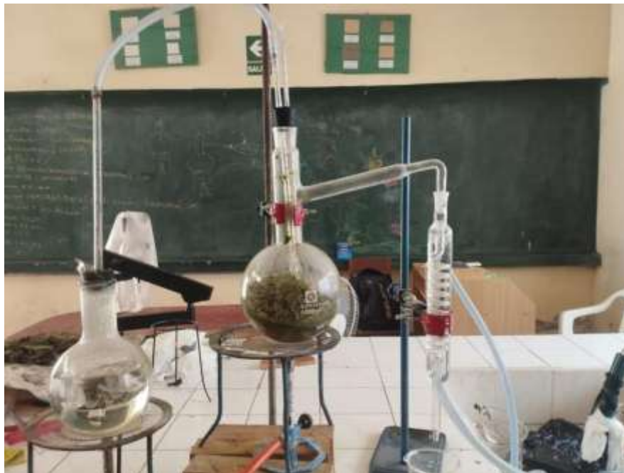
Foto 16. Extracción por arrastre de vapor de hojas
