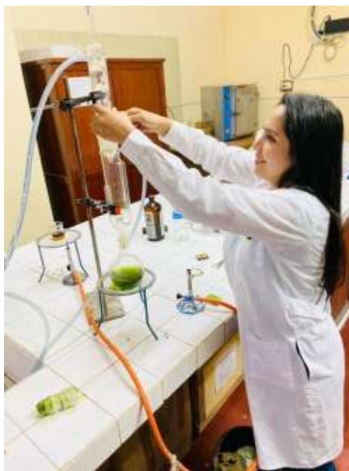
Foto 09 y 10. Extracción continua con solventes orgánicos de hojas
