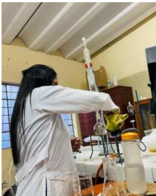
Foto 13. Extracción continua con solventes orgánicos de la raíz
