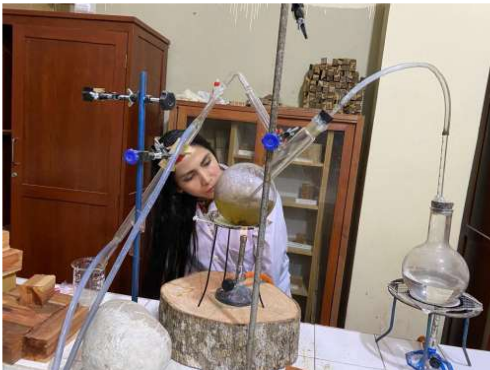
Foto 17. Extracción por arrastre de vapor de tallo
