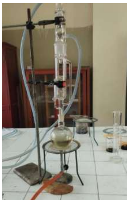
Foto 11 y 12. Extracción continua con solventes orgánicos del tallo
