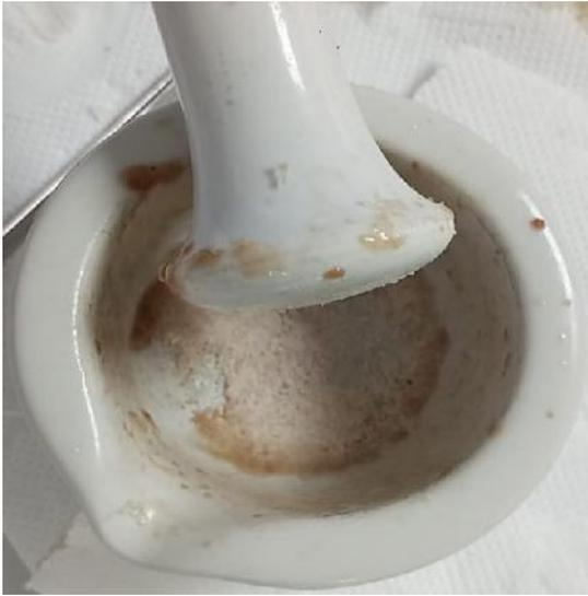
Fragmentación de paramphistomidos con nitrógeno líquido a  $-195\text{ }^{\circ}\text{C}$
