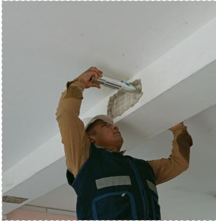
**Figura. 29:** Ensayo de Esclerometría en el fondo de la viga.
