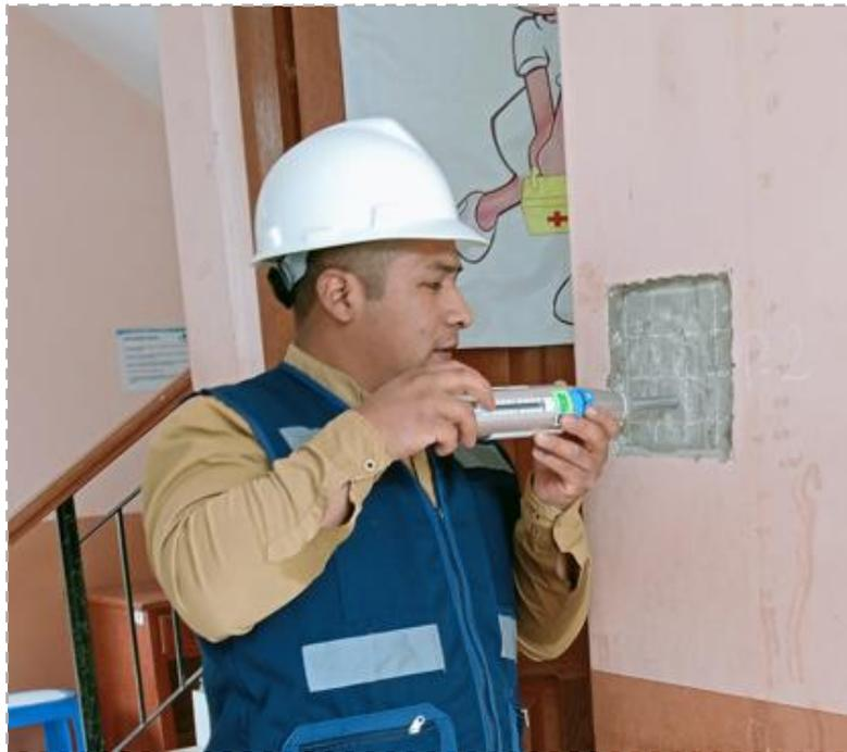
**Figura. 27:** Ensayo de Esclerometría en la parte superior de la Columna.
