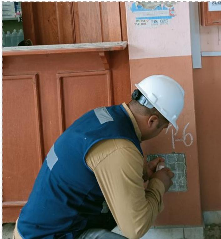
**Figura. 26:** Ensayo de Esclerometría en parte central de la Columna.
