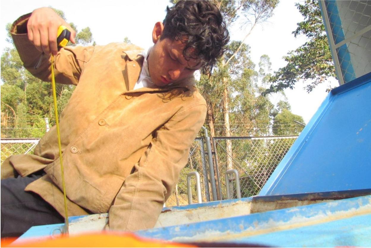
**Fotografía 12.** Medición de niveles del reservorio 3:00 P.m.
