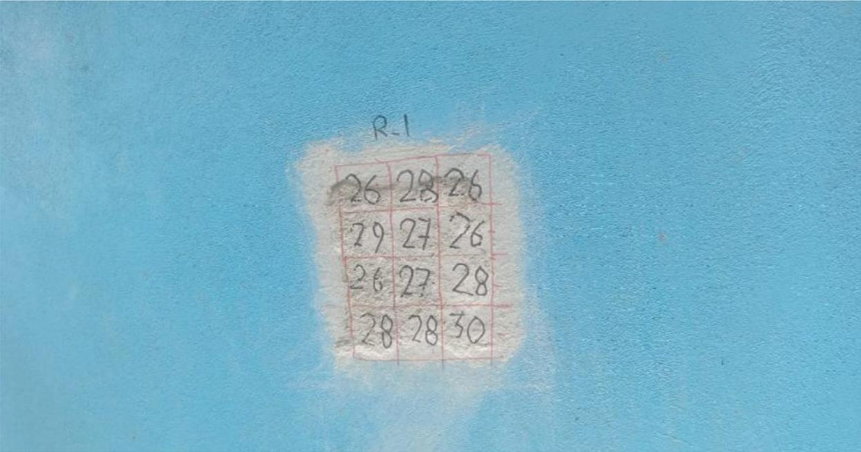
**Fotografía 32.** Ensayo de Esclerometría S.A.P. CAPELLANÍA CHÁVEZ
