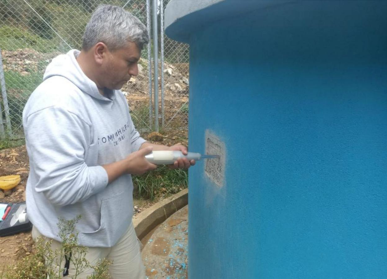
Fotografía 33. Ensayo de Esclerometría S.A.P. RETAMAMAYO
