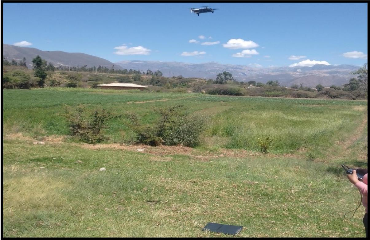
**Anexo 10:** Levantamiento topográfico con dron en el caserío Limapampa (ortofoto).
