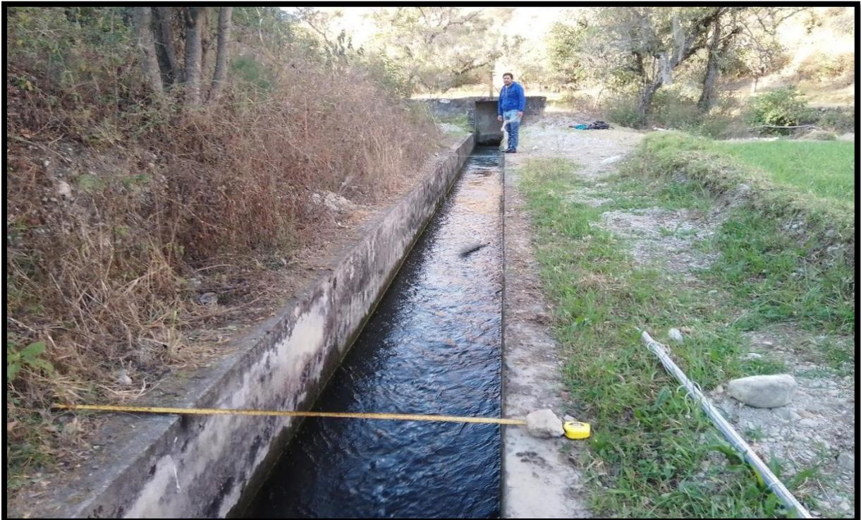
**Anexo 3:** Noveno aforo en la conducción del canal de riego, método tubo de Pitot.
