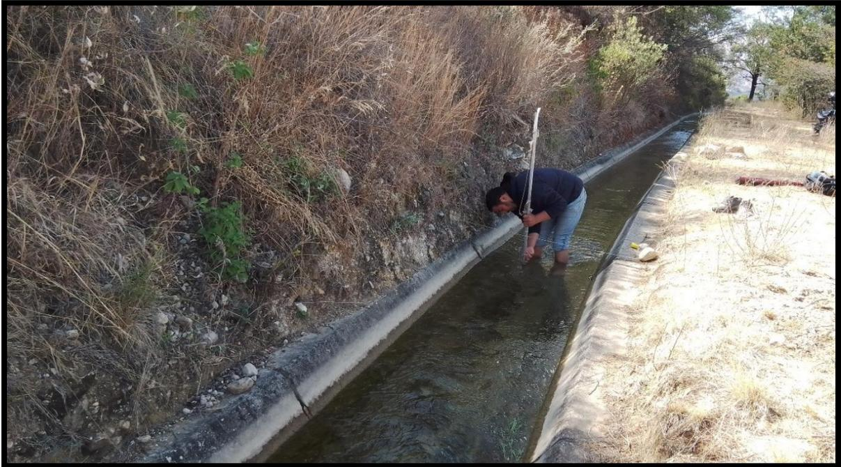
**Anexo 4:** Aforo en la distribución del canal de riego en el caserío Marcopampa, método del correntómetro.
