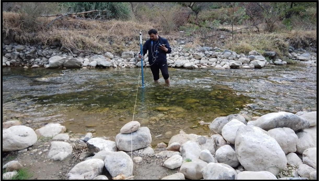
**Anexo 2:** Sexto aforo en la captación del canal de riego, método del flotador con tulula.
