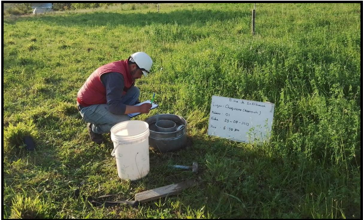
**Anexo 26:** Prueba de infiltración en el terreno de cultivo de muestra en el caserío Limapampa.
