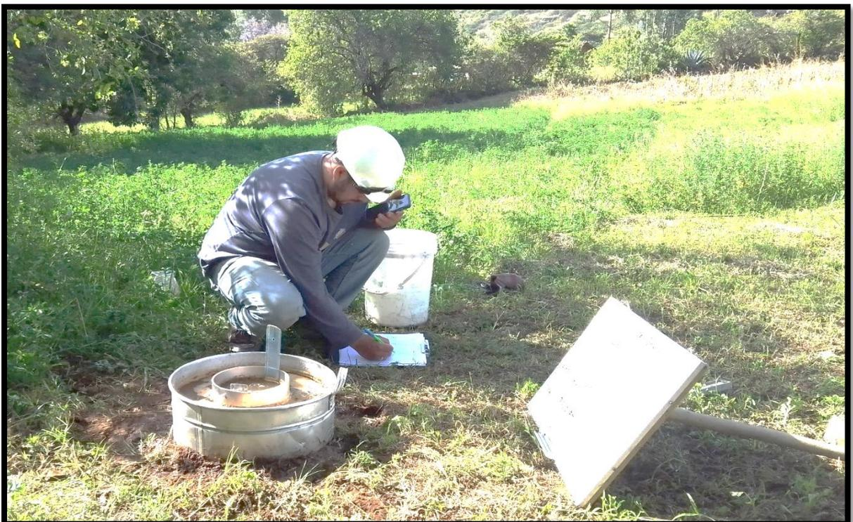
**Anexo 25:** Prueba de infiltración en el terreno de cultivo de muestra en el caserío Chuquiamo con sistema de riego por aspersión.
