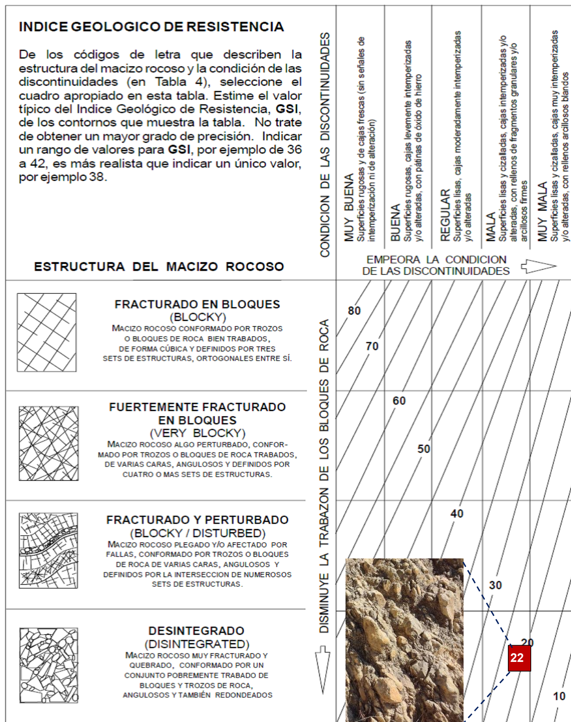
Figura 3.28: GSI = 22 de la estación EG – 03, según la condición del macizo rocoso se encuentra desintegrado.
