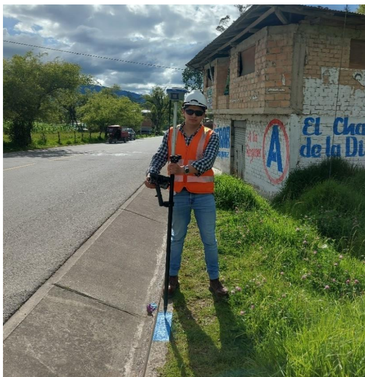
Fotografía 5. Marcado y toma del BM-12 en el tramo final Chota – Bambamarca
