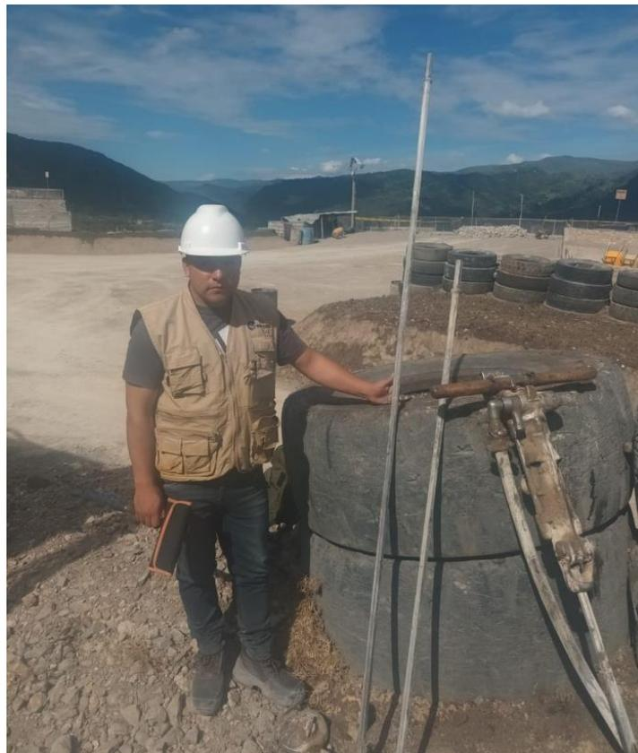
Figura 22: Barrenos de perforación de 4 y 6 pies de la mina Bendición de Dios, Bambamarca
