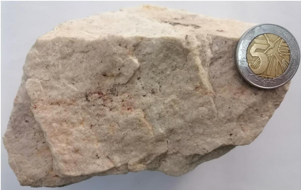
Figura 3.9. Muestra de arenisca de grano medio con matriz cementante silicificada con superficie de roca plana granulada, constituyendo la sección de túnel.
