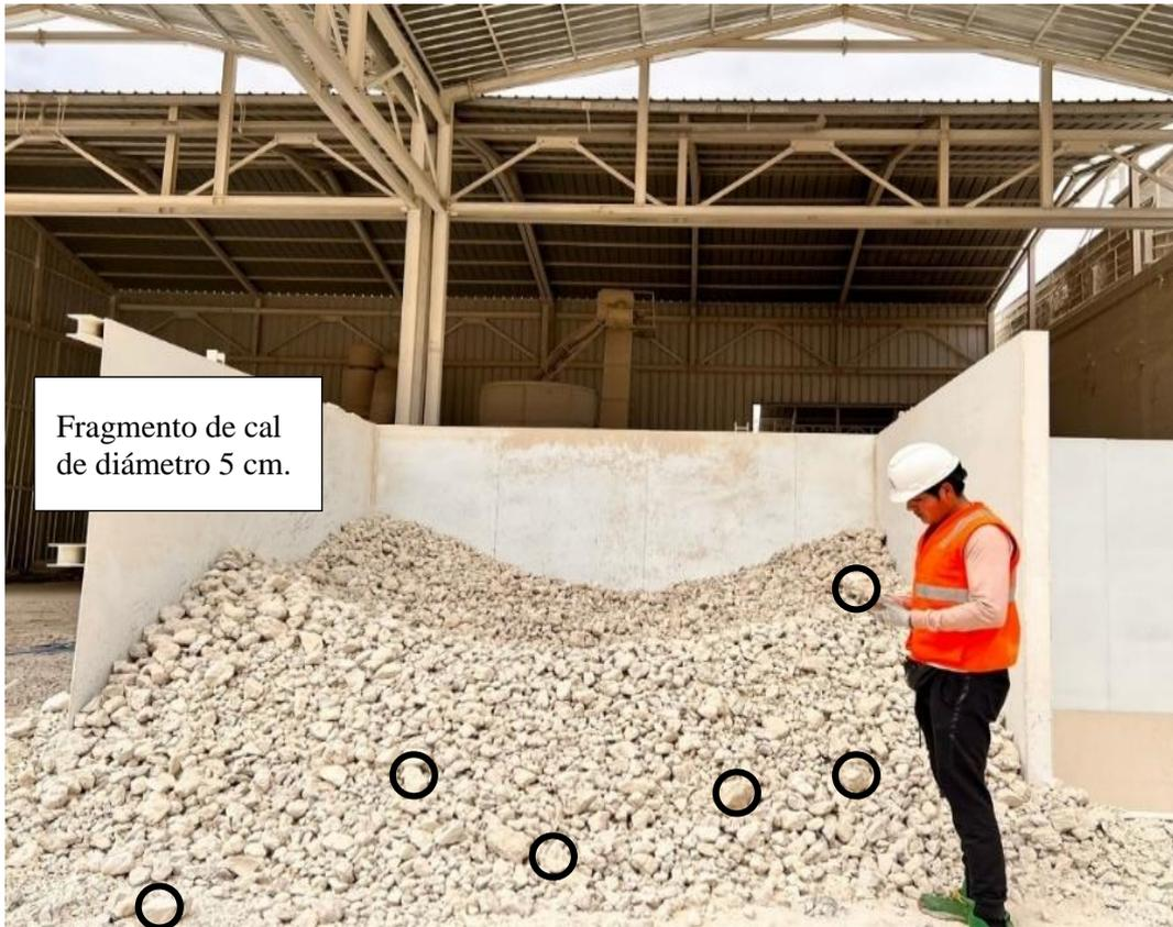
**Fotografía 3.** Fragmento de cal de diámetro 5cm después de ser calcinado y triturado por la chancadora primaria.
