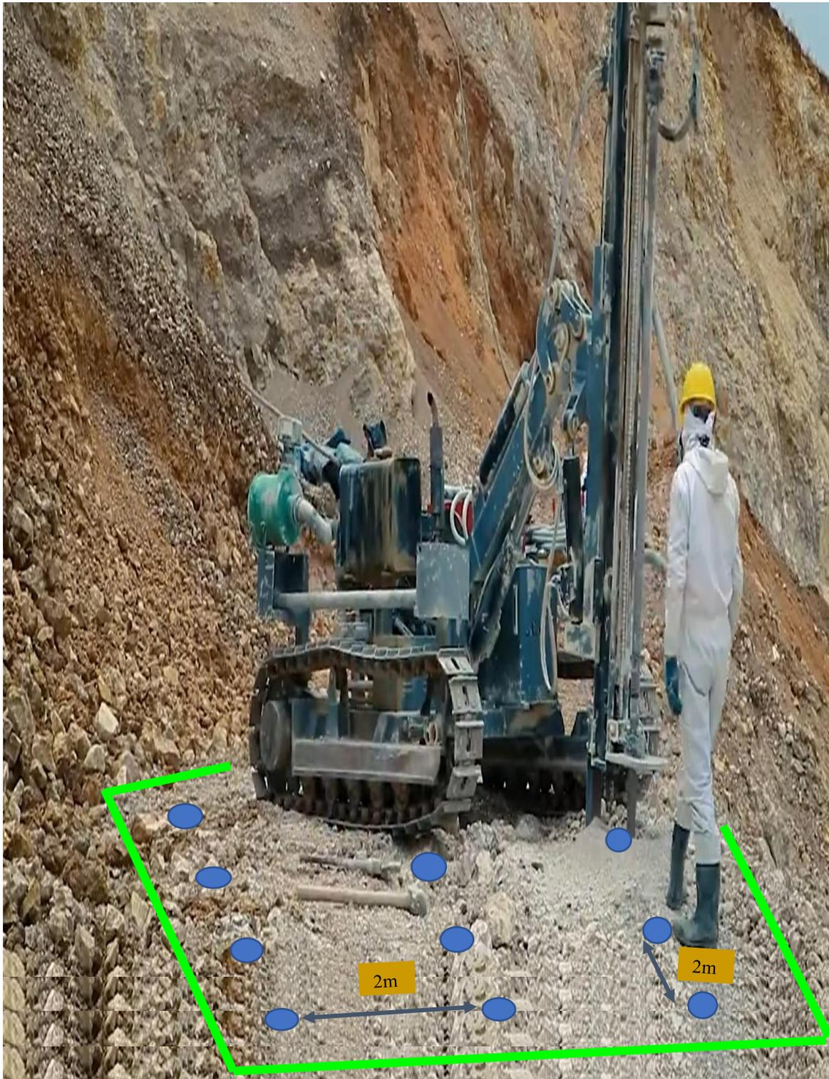
**Fotografía 7.** Proceso de perforación con AirRoc T25 en la cantera el Zasal.
