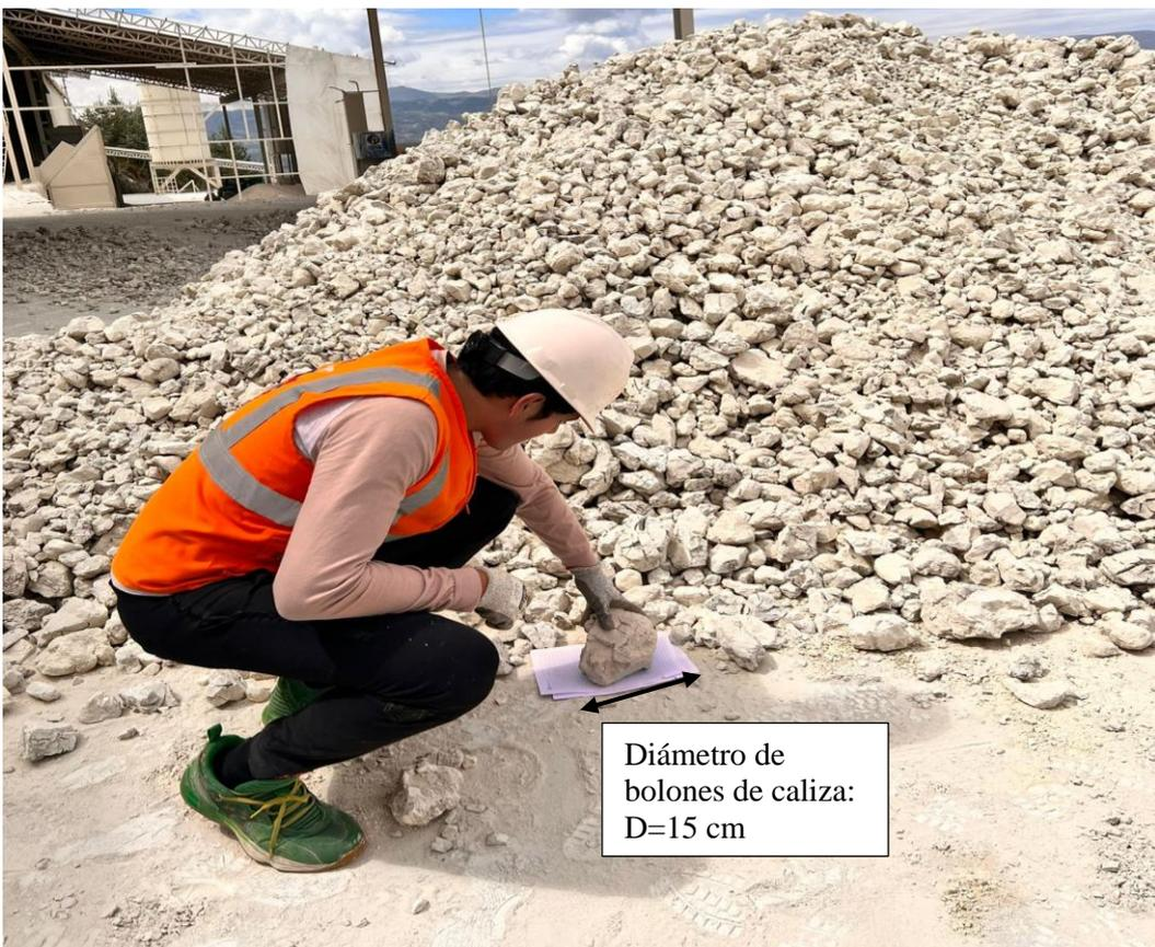
**Fotografía 2.** Pila de Caliza con bolones de diámetro de 15cm.
