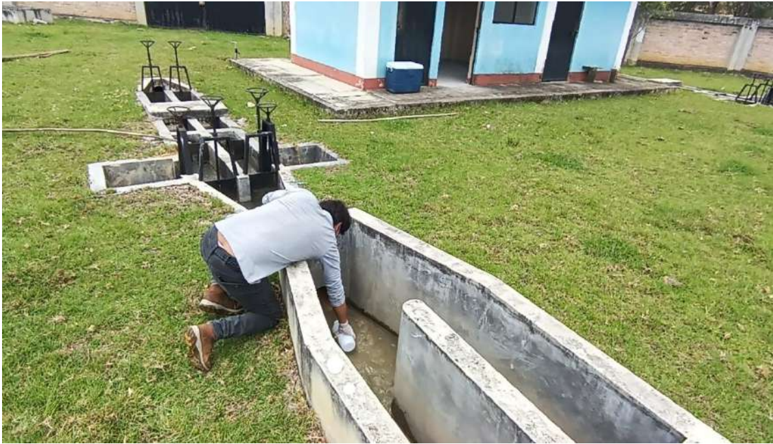
Fotografía N°3. Toma de muestras a la salida del desarenador N°1, fecha 23 de octubre del 2024.
