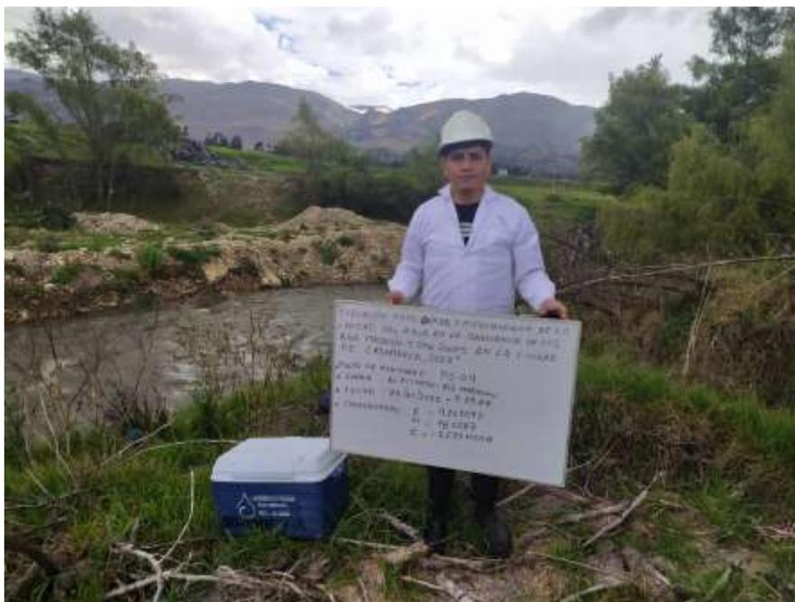
Fotografía 10: Toma de muestra en el punto PC-04 (Río Mashcón), para determinar parámetros bacteriológicos y parasitológicos
