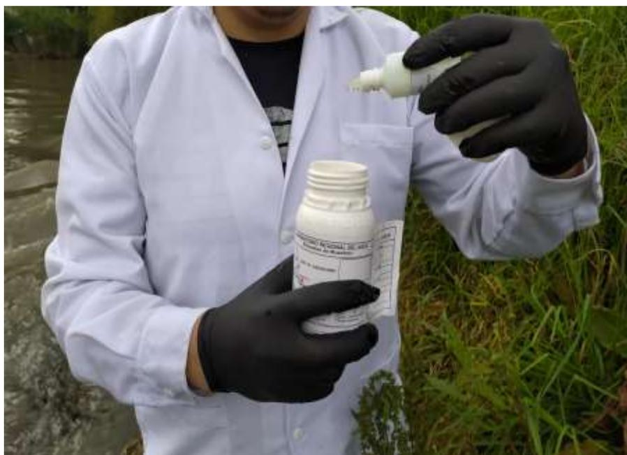
Fotografía 7: Preparación de la muestra de agua para determinar oxígeno disuelto.
