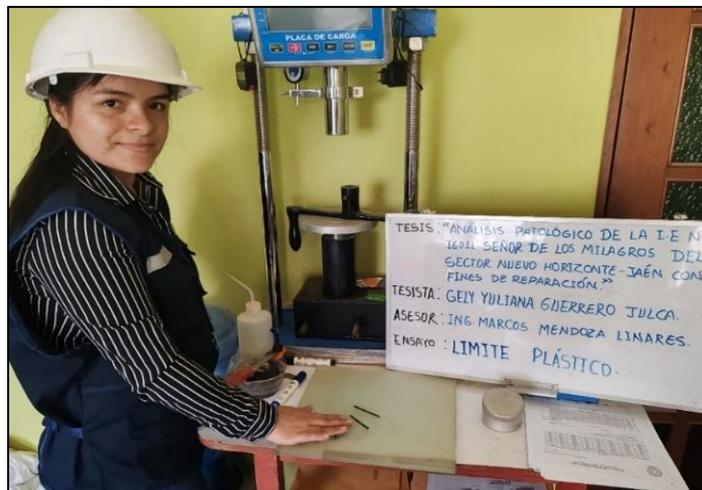
**FOTOGRAFIA 5:** Ensayo de límite plástico del suelo.
