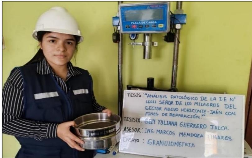
**FOTOGRAFIA 3:** Ensayo de Granulometría.
