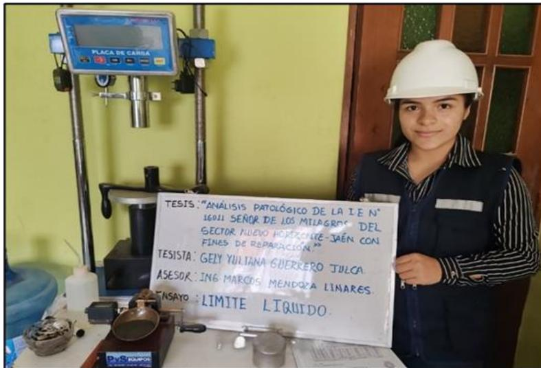
**FOTOGRAFIA 4:** Ensayo de del límite liquido del suelo.
