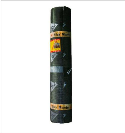
*Nota:* La imagen muestra una membrana impermeabilizante prefabricada a base de asfalto modificado con APP (Polipropileno Atáctico). Cuenta con un refuerzo central compuesto de fibra de vidrio o poliéster no tejido, y se encuentra disponible en diversos acabados y colores. Tomado de («Una membrana asfáltica para impermeabilizar cubiertas - SIKA® MANTO APP», s. f.)
