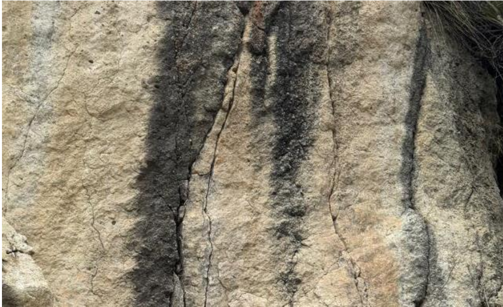
Foto 08: Diaclasas de 1.5 cm. en rocas volcánicas, orientación de foto de SW – NE.
