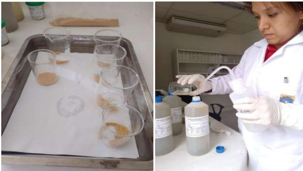
**Figura 10** Agregado de las respectivas dosis del coagulante en las diferentes muestras de agua residual doméstico, se agito constante por 1 minuto y una agitación lenta por 15 minutos.
