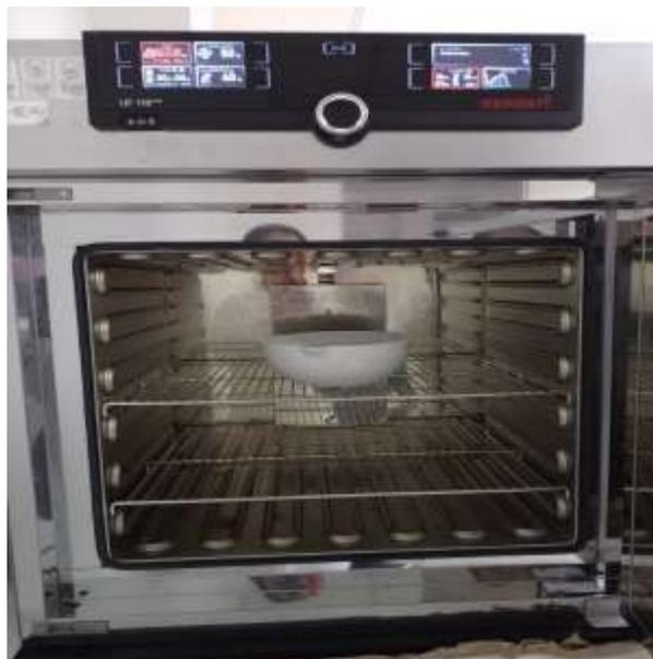
**Figura 1** secado de semillas en horno Memmert UF110
