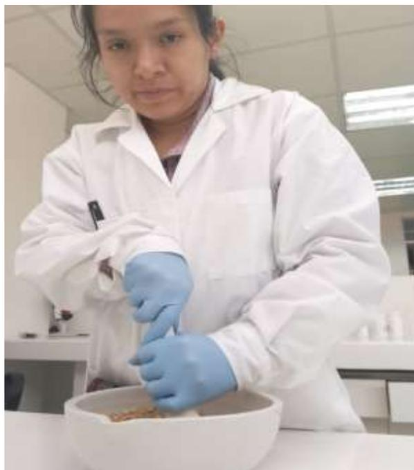
**Figura 3** Trituración de semillas de *M. oleifera* en capsula de porcelana y mortero
