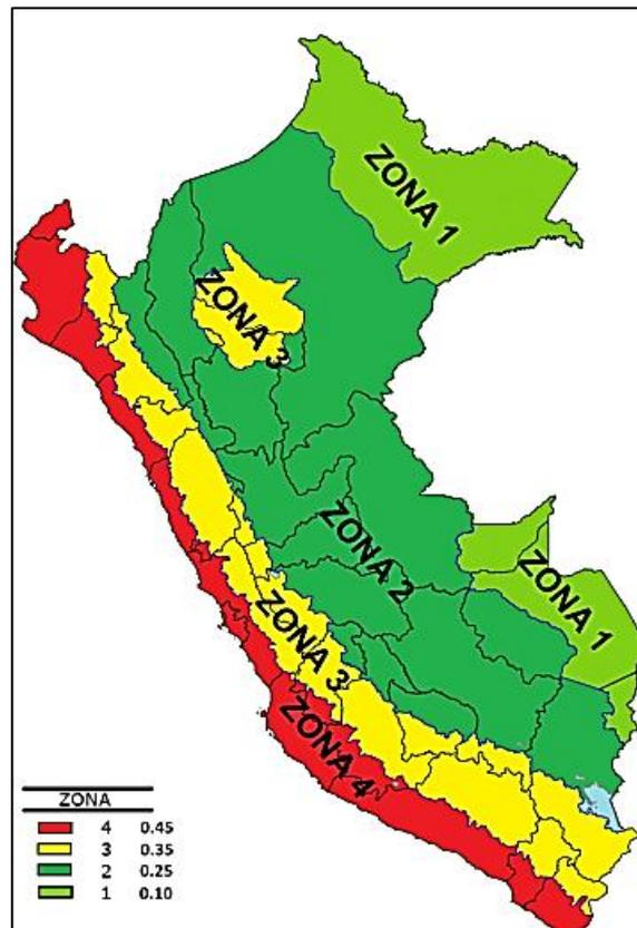
**Figura 8.** Zonificación sísmica del Perú.
