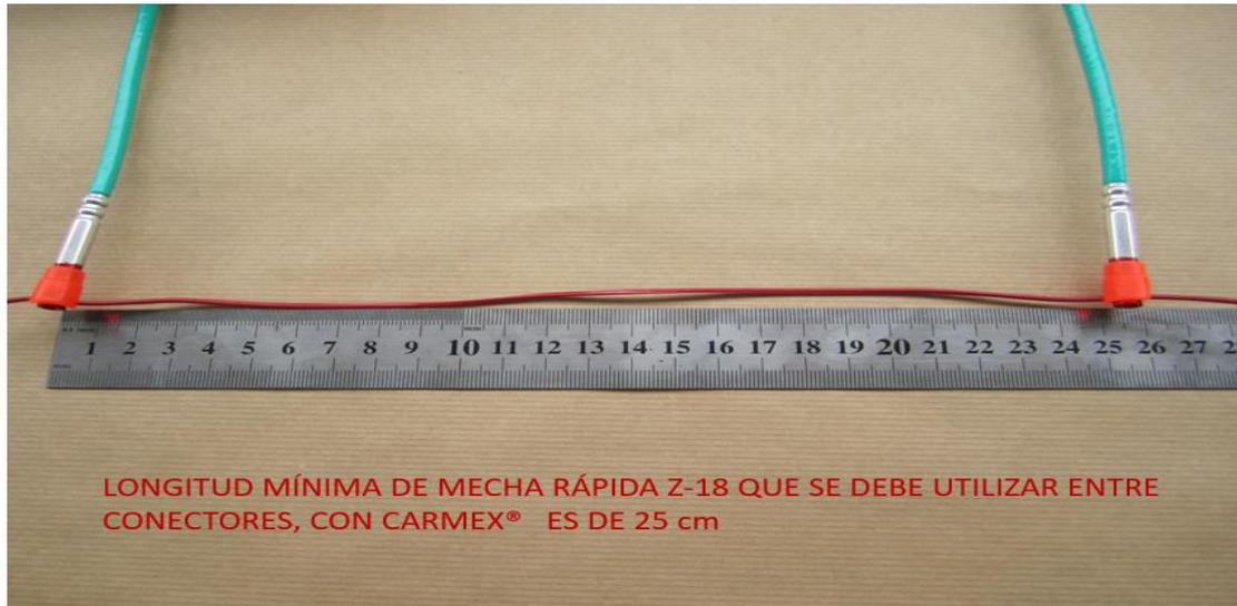
**Figura 9.** Distancia entre conectores para garantizar la correcta secuencia.
