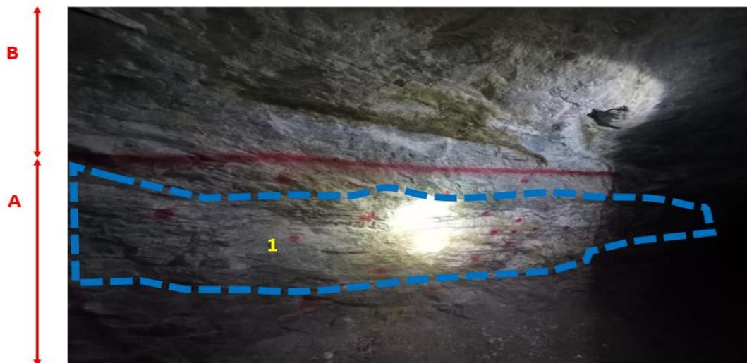
**Figura 25.** Marcación de malla de circado en la labor del M.A N°2, se muestra la parte mineralizada en la parte A.
