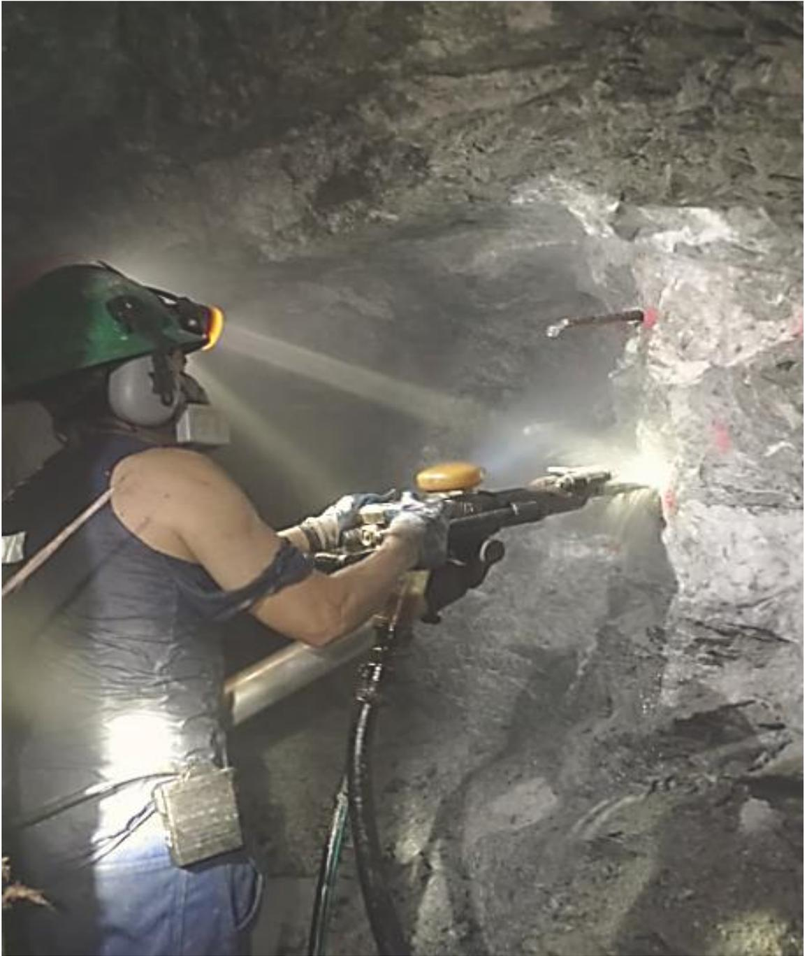
**Anexo 2.** Fotografía de perforación de malla marcada en la labor del M. A N°1.
