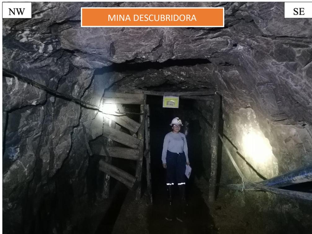
Figura 3.3. Nivel 4 – Mina Descubridora, ingreso a las instalaciones subterráneas de la Mina Descubridora de dimensiones 1.80 m. x 2.10 m., constituida por roca diorítica.
