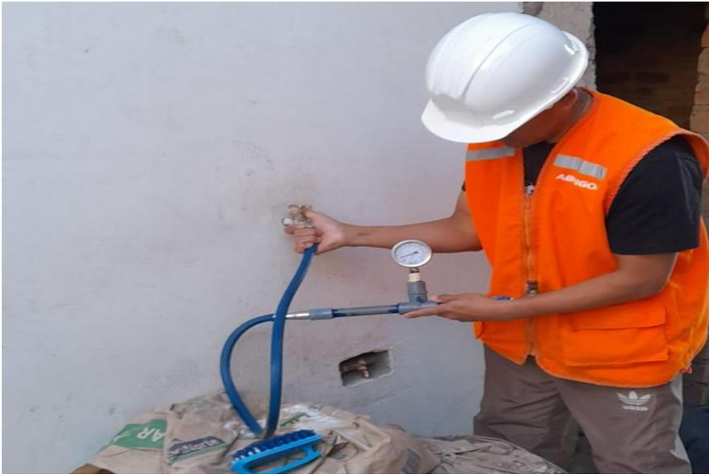
**Fotografía 11:** toma de lectura de la presión dinámica haciendo uso del manómetro
