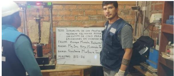
**Foto 37:** Ensayos de resistencia a compresión en muretes
