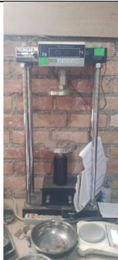
**Foto 35:** Equipo utilizado para determinar resistencia a la tracción del mortero
