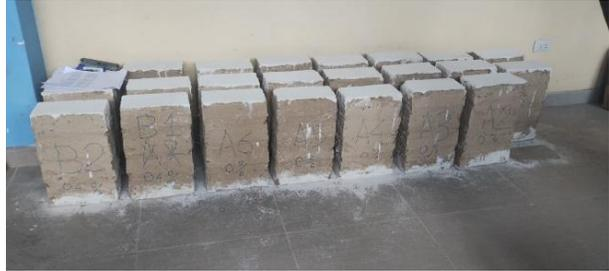
**Foto 27:** Toma de datos en muretes para ensayos a compresión
