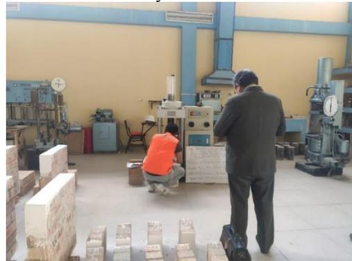
**Foto 31:** Muestras a ensaya resistencia a flexión
