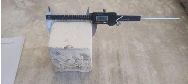
**Foto 22:** Toma de datos de unidades de adobe para ensayos a tracción
