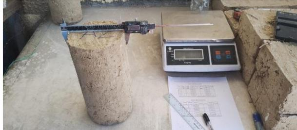
**Foto 23:** Toma de datos de unidades de adobe para ensayos a flexión
