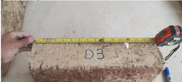
**Foto 24:** Toma de datos de unidades de adobe para ensayos a tracción de mortero
