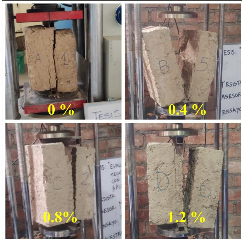
*Tabla 11: Resultados de esfuerzos en ensayos a tracción de mortero entre adobes*
