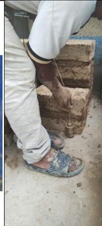
**Foto 21:** Toma de datos de unidades de adobe para ensayos a compresión
