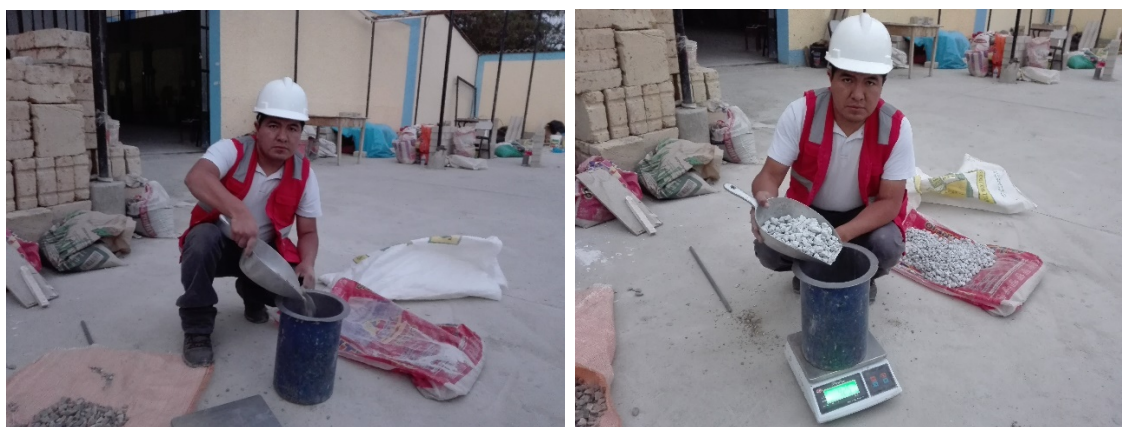
Figura 7: Ensayo de peso unitario suelto seco de los agregados fino y grueso.
