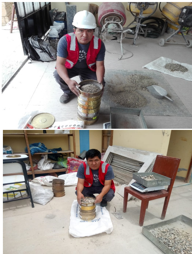
Figura 3: Tamizado del agregado tanto fino como grueso para la obtención de su granulometría.
