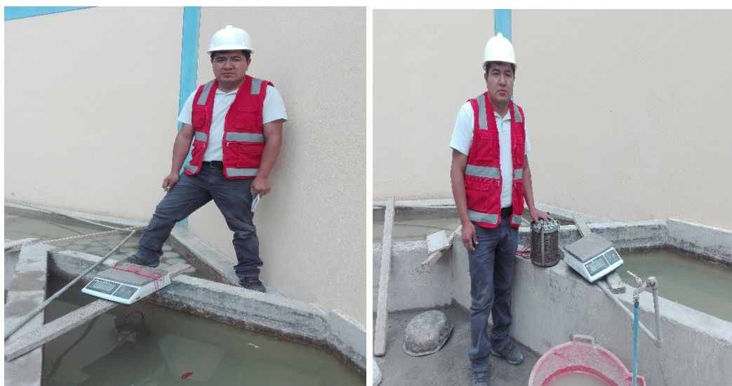
Figura 4: Ensayo de peso específico del agregado grueso.
