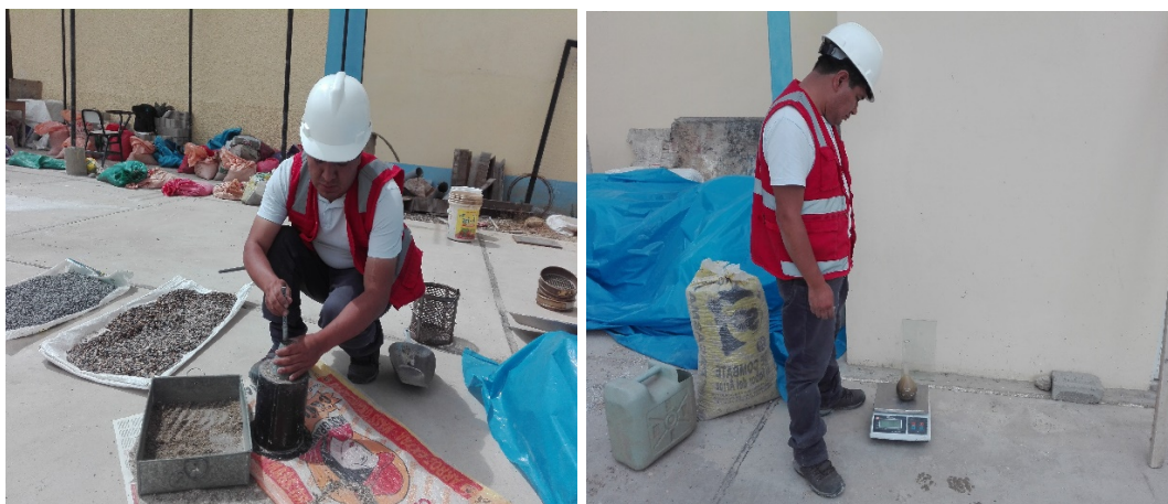
Figura 5: Ensayo de peso específico del agregado fino.
