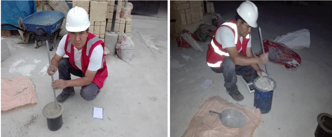
Figura 8: Ensayo de peso unitario seco compactado de los agregados fino y grueso.
