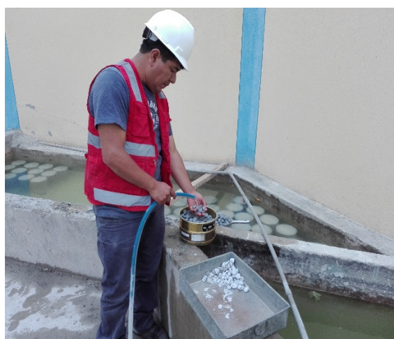
Figura 6: Ensayo de lavado del agregado para determinar las partículas que pasan el tamiz N° 200.
