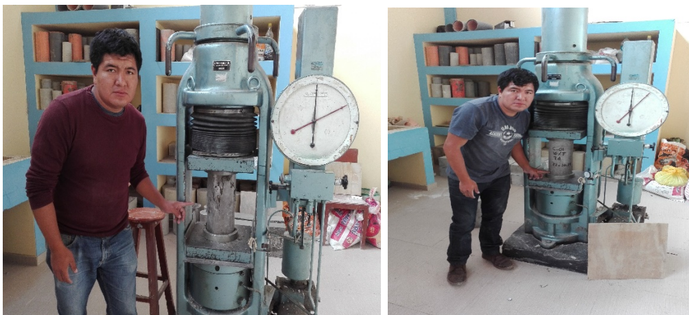
Figura 10: Ensayo a compresión de los especímenes cilíndricos en la prensa universal.
