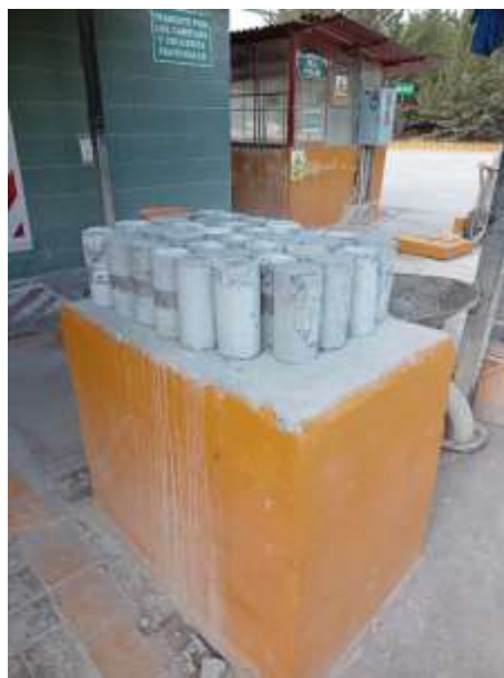
Foto N° 08: Probetas de concreto ensayadas a compresión.
