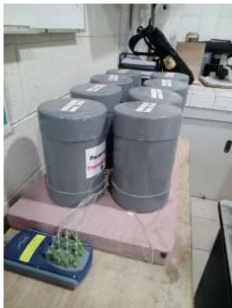
Foto N° 05: Registro de temperatura del concreto.
