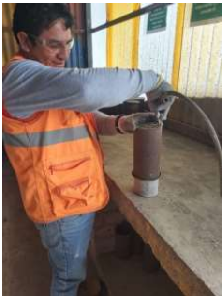
Foto N° 07: Desmolde de probetas con compresor de aire.
