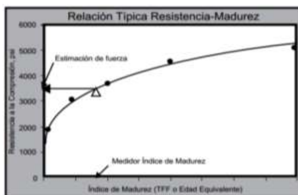
Figura 03. Relación Resistencia vs Madurez.
