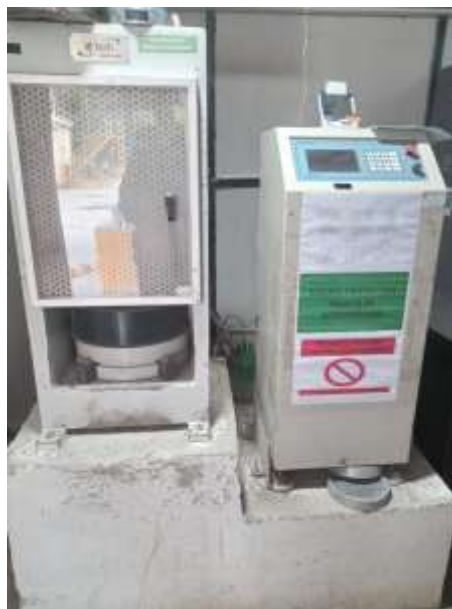
Foto N° 06: Ensayos de resistencia a compresión de probetas de concreto.
