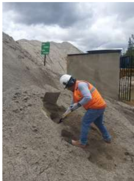
Foto N° 01: Cuarteo y obtención de muestra representativa de agregados para ensayos de laboratorio.
