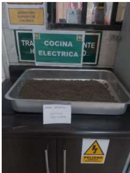
Foto N° 02: Ensayo de peso unitario de agregado fino
