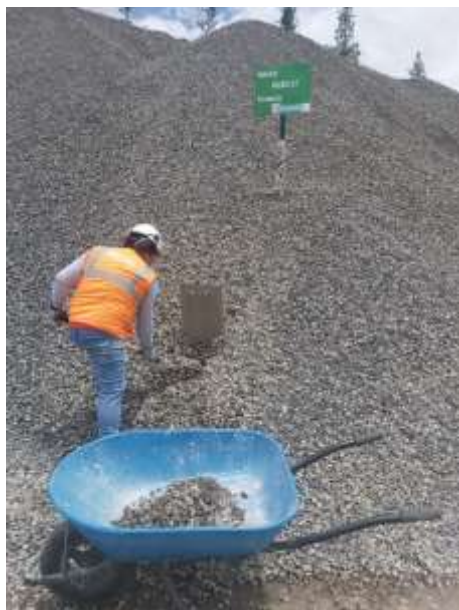
Foto N° 01: Cuarteo y obtención de muestra representativa de agregados para ensayos de laboratorio.
