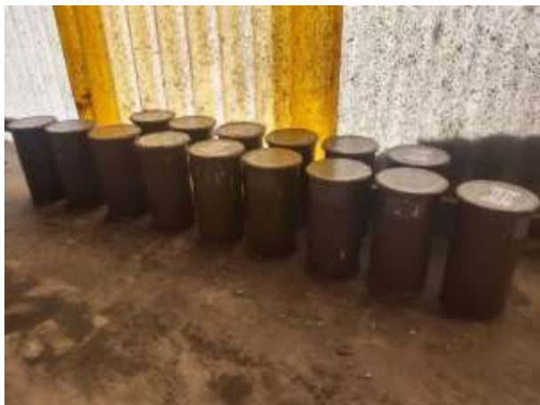
Foto N° 03: Elaboración de probetas de concreto para ensayo de resistencia a compresión.
