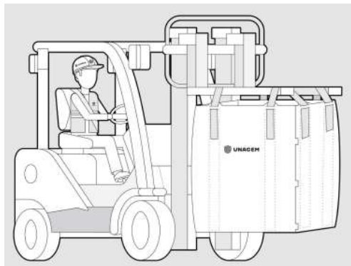
Figura 18: Descarga de Big Bag usando montacargas
