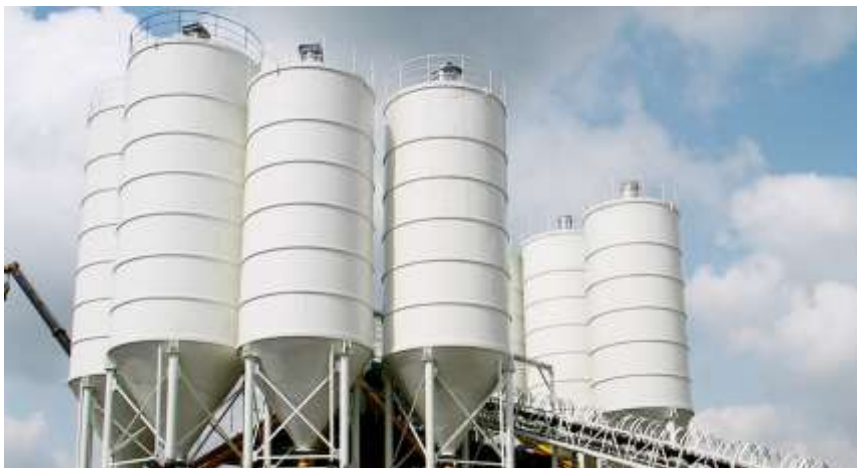
Figura 19: Silos de almacenamiento de cemento
