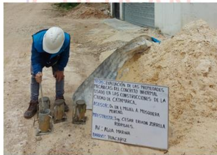
FOTOGRAFÍA N°8. Elaboración de probeta: Barrio Huacariz - Av. Agua Marina.
