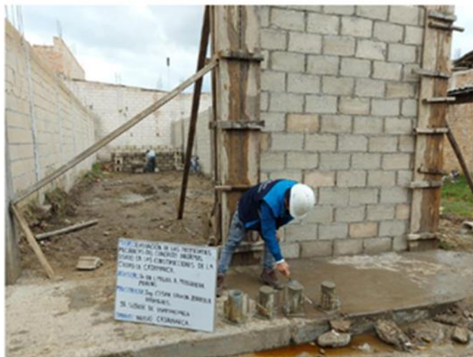
FOTOGRAFÍA N°7. Elaboración de probeta: Nuevo Cajamarca - Jr. Señor De Huamantanga.
