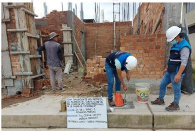
FOTOGRAFÍA N°2. Elaboración de probeta: Mollepampa - Jr. Maria Goreti.
