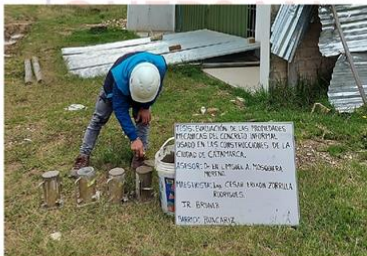
FOTOGRAFÍA N°6. Elaboración de probeta: Barrio Huacariz - Jr. Bruner.
