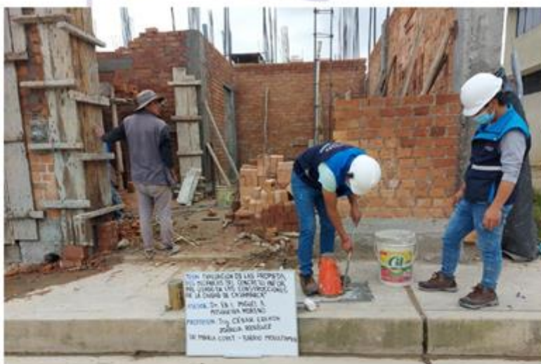
FOTOGRAFÍA N°2. Elaboración de probeta: Mollepampa - Jr. Maria Goreti.
