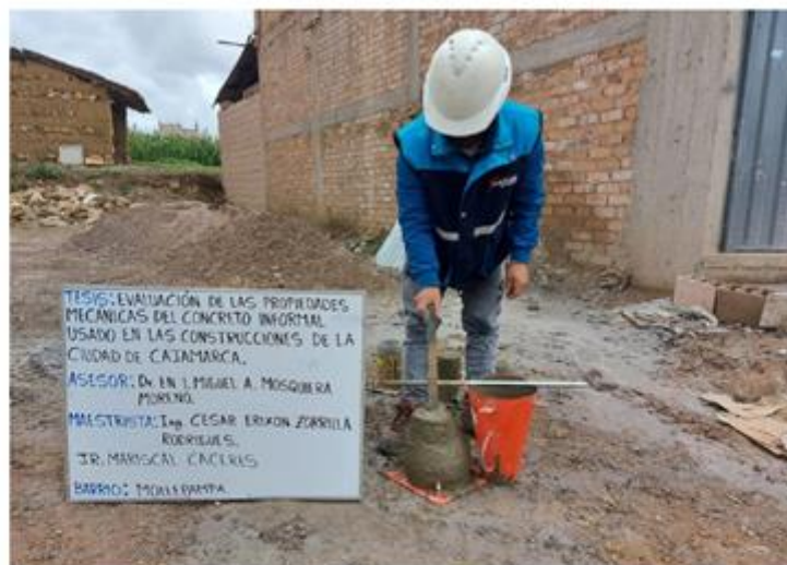
FOTOGRAFÍA N°7. Elaboración de probeta: Mollepampa - Jr. Mariscal Caceres.
