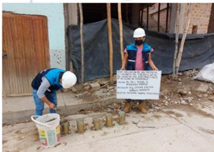
FOTOGRAFÍA N°6. Elaboración de probeta: Mollepampa - Jr. 23 De Setiembre.
