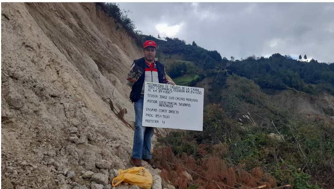
Figura 26 Calicata y recolección de muestra en el km 85+300.
