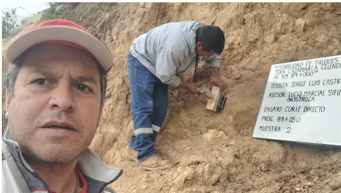
Figura 30 Calicata y recolección de muestra en el 88+050.
