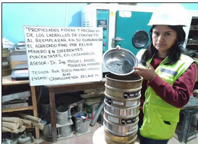
Foto 2 Ensayo de granulometría del Relave Minero
