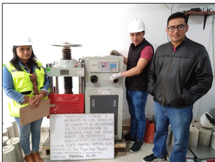
Foto 8 Ensayo de Resistencia a compresión de los ladrillos de concreto
