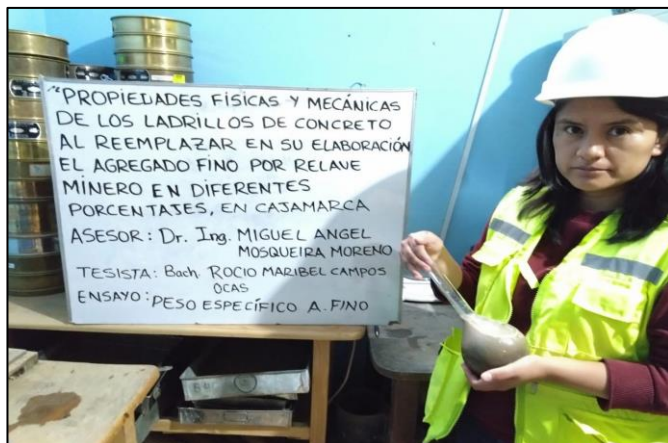
Foto 3 Ensayo de Peso específico del Agregado Fino
