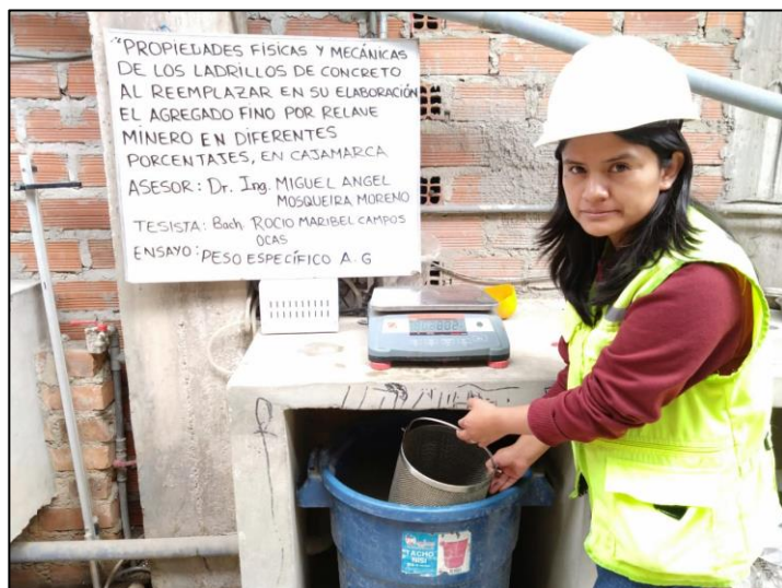
Foto 4 Ensayo de peso específico del Agregado Grueso
