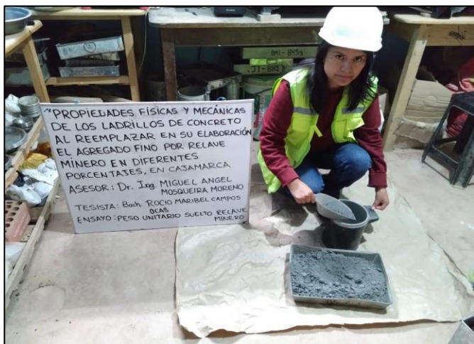
Foto 1 Ensayo de peso unitario suelto Relave Minero
