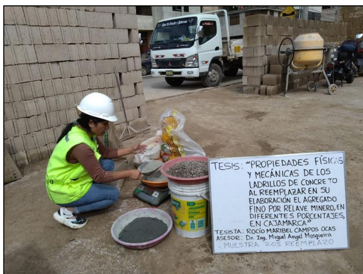
Foto 5 Peso de la cantidad de materiales para la elaboración de ladrillos de concreto
