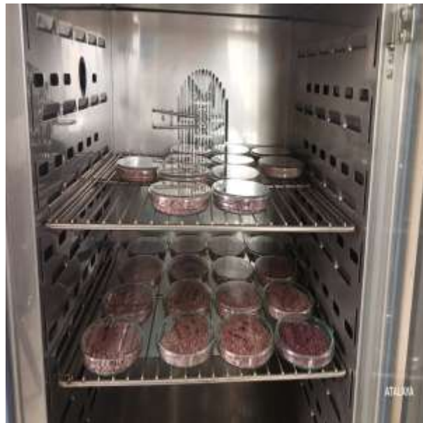
Muestras de snacks de harina de maíz morado y harina de quinua en estufa (proceso de secado)
