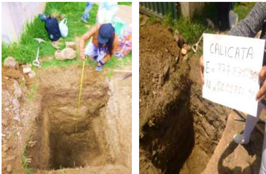
Figura 36 Realización de la excavación (Calicata 2)
