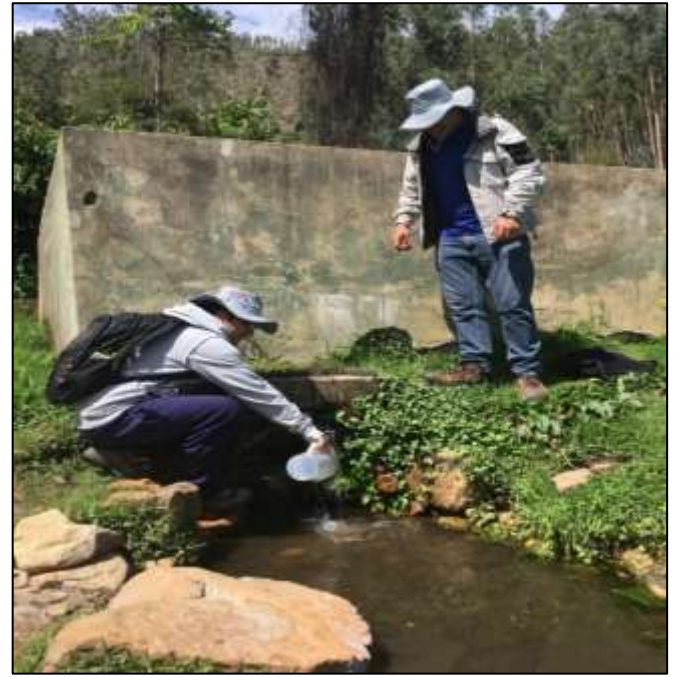
Figura 33. Toma de datos de aforo dentro de la cuenca hidrográfica Rejo.
