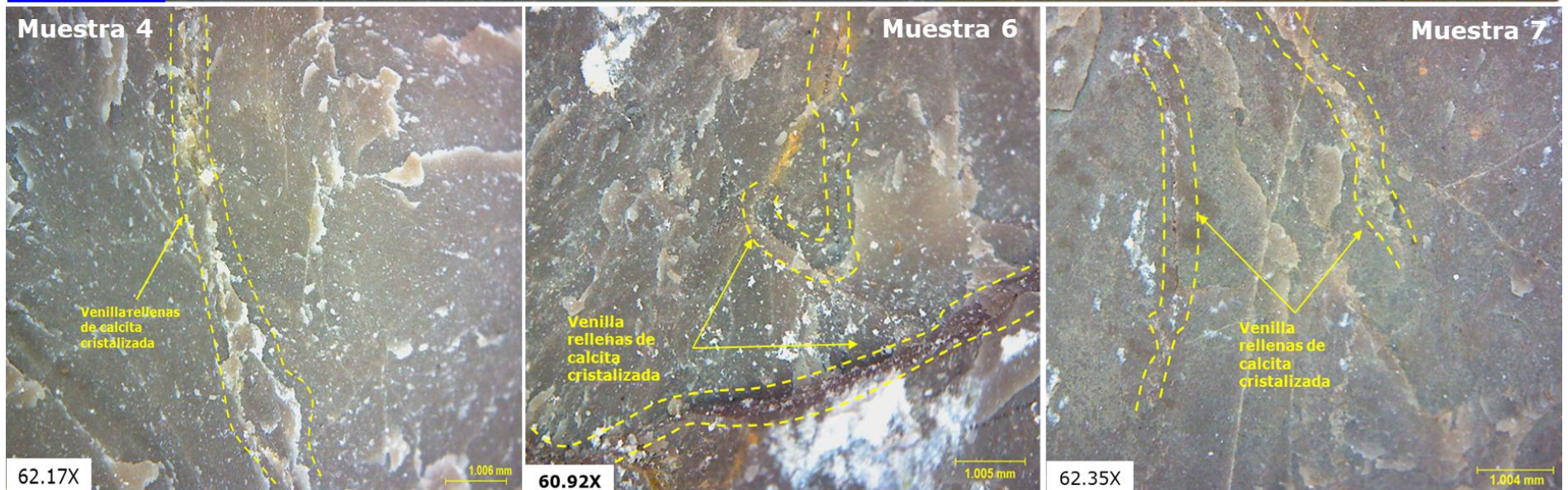
Figura 24. Calizas Mudstone de la Formación Cajamarca al microscopio con mínima cantidad de clastos.
