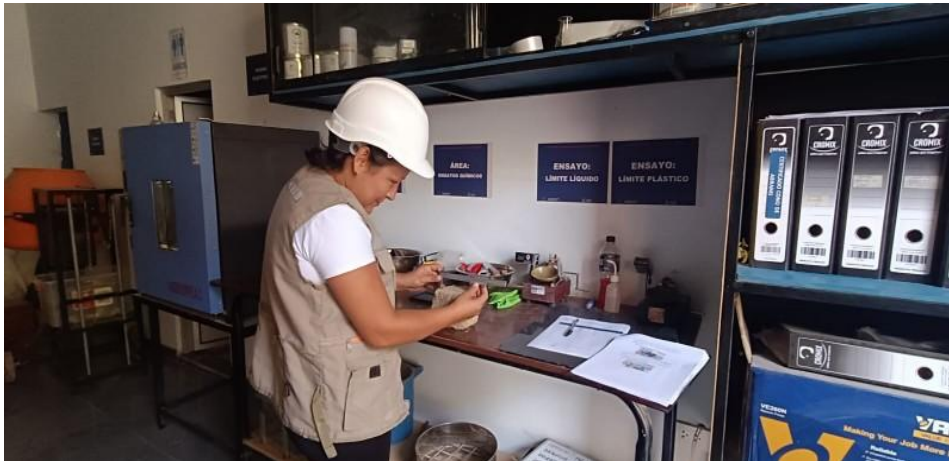
Foto 10. Medición de cubos de adobe con el vernier.
