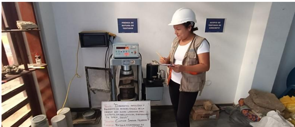
Foto 11. Ensayo a la compresión de muestra de adobe.
