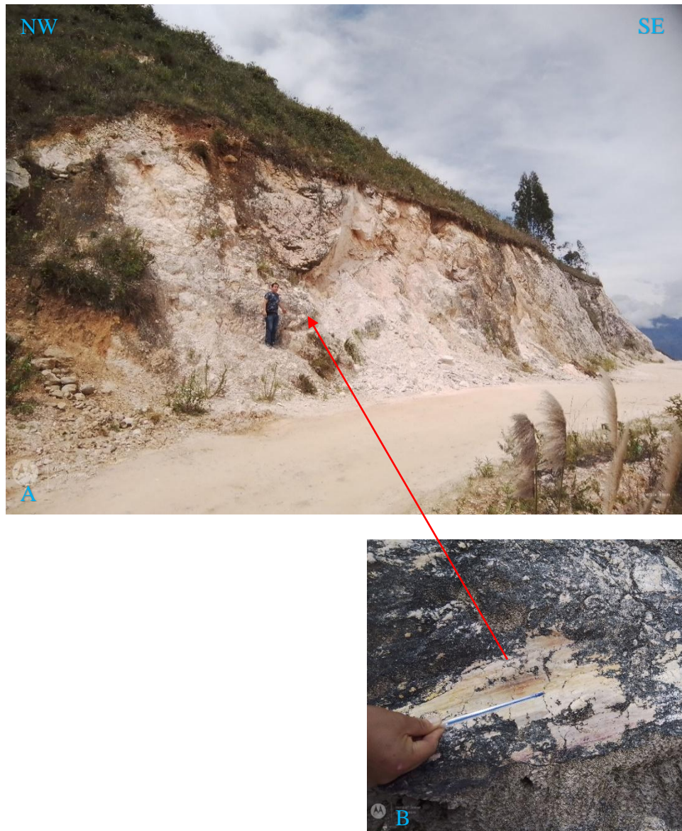
Figura 24: A. Se ubica en la Formación Farrat, en el lado izquierdo de la carretera, presentando falla IxDx. B. Indicadores cinemáticos del espejo de falla.
