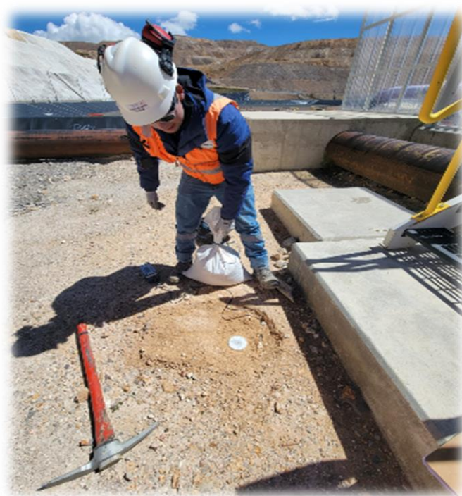
Foto 4 Al geófono se le coloca un peso para mejor registro
