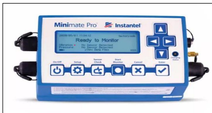
Figura 16. Sismógrafo que mide el nivel de vibraciones.
