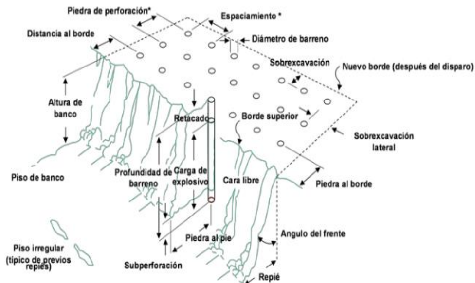
Figura. 14 Componentes de una malla de perforación.
