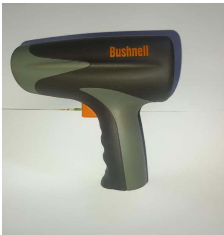
Fotografía N° 5: Pistola radar Bushnell para medir Velocidades de operación en campo
