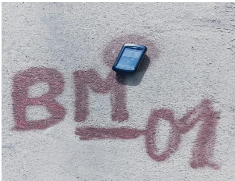
Fotografía N° 4: Pintura de aerosol para marcado de BMs
