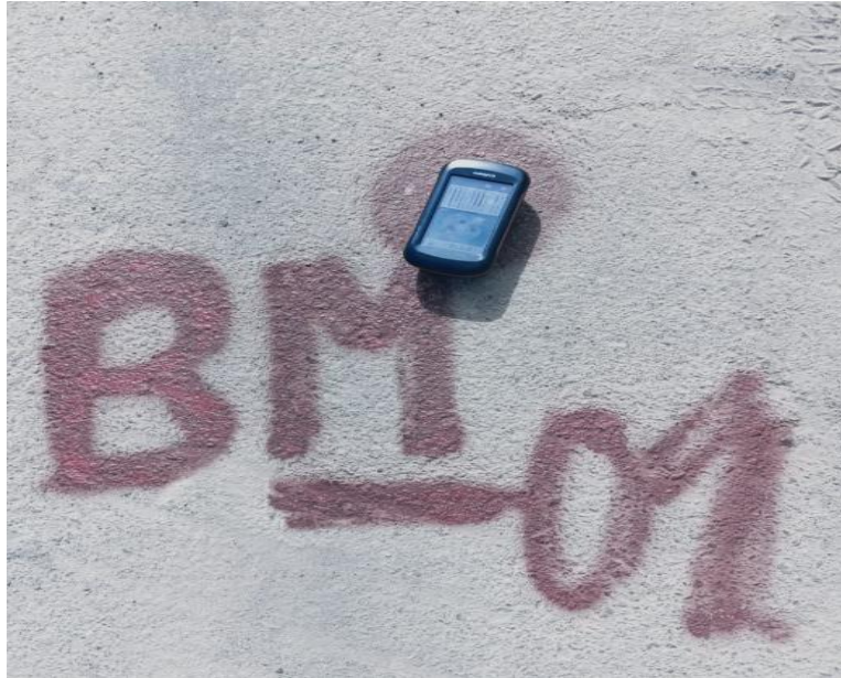
Fotografía N° 7: GPS de mano tomando coordenadas del punto de referencia
