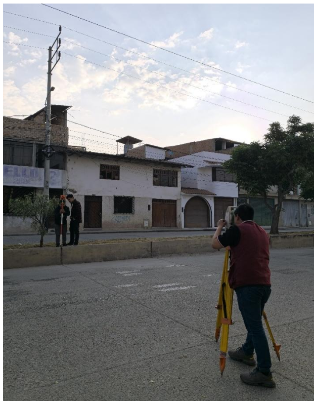
Figura 162. Levantamiento topográfico haciendo uso de estación y prisma.
