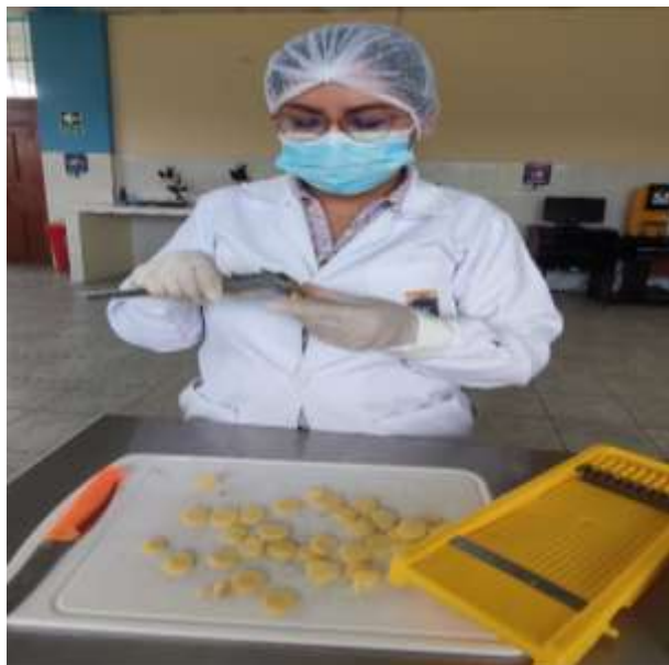
Medida de diámetro de hojuelas con vernier
