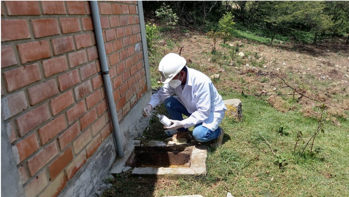
Figura 33. Toma de muestras para DQO en el afluente del punto de monitoreo BP1.
