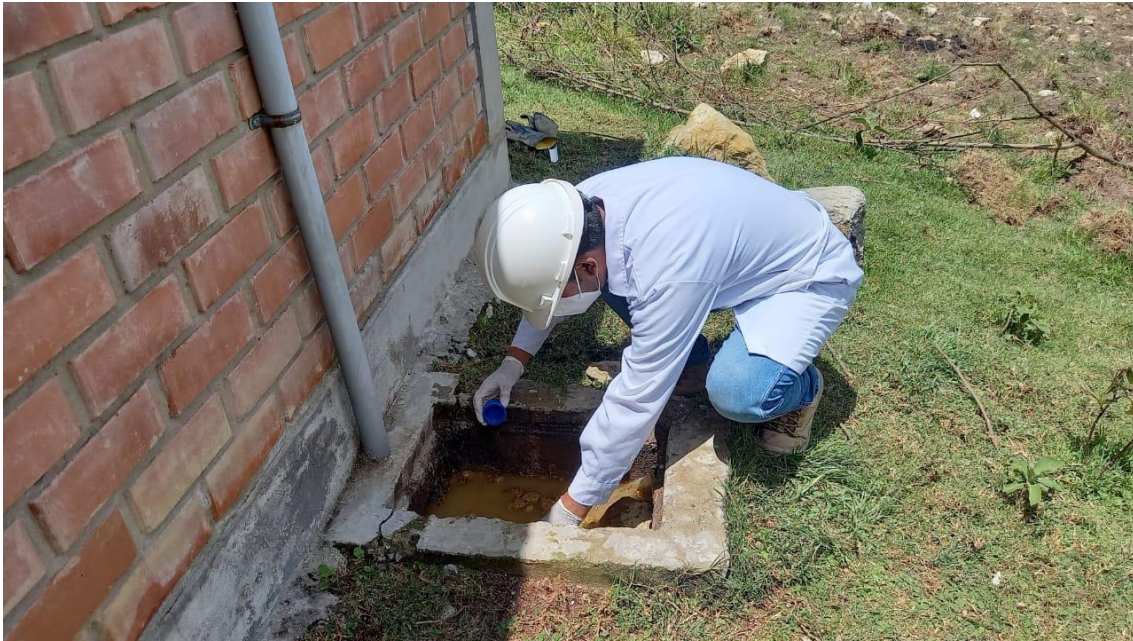
Figura 31. Toma de muestras para Coliformes Termotolerantes en el afluente del punto de monitoreo BP1.
