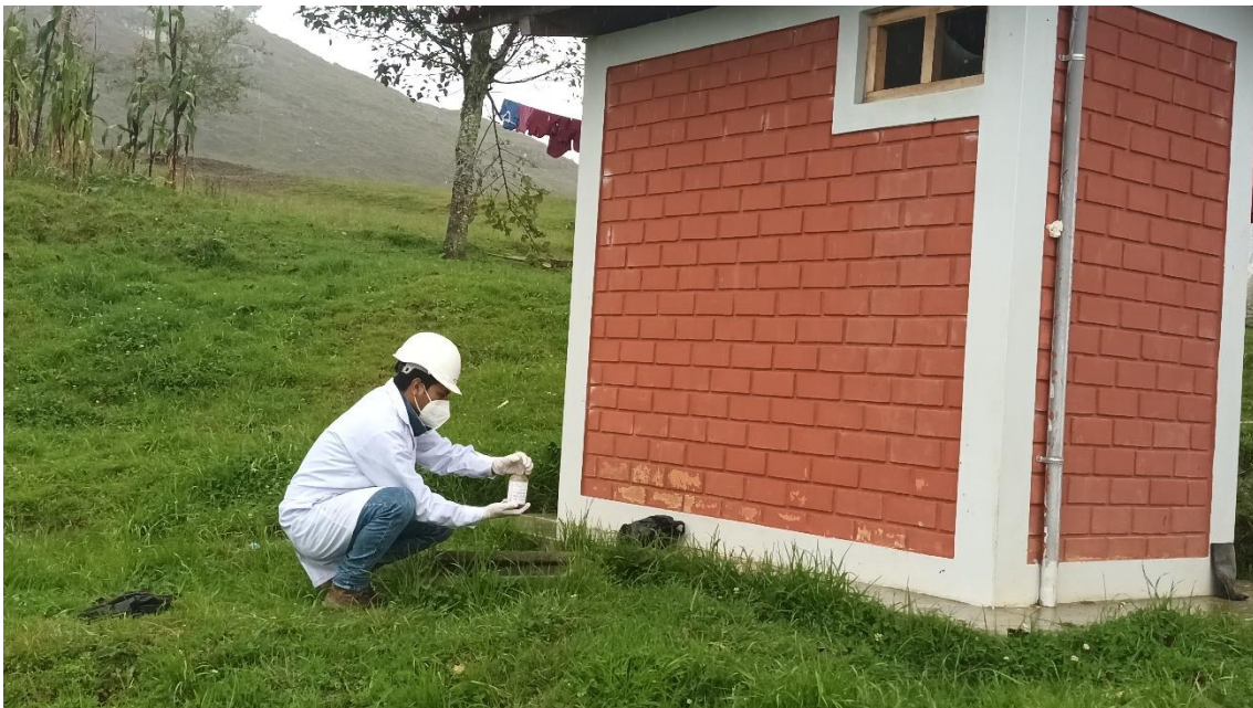
Figura 36. Toma de muestras para Coliformes Termotolerantes en el afluente del punto de monitoreo BP4 a 2641 m.s.n.m.
