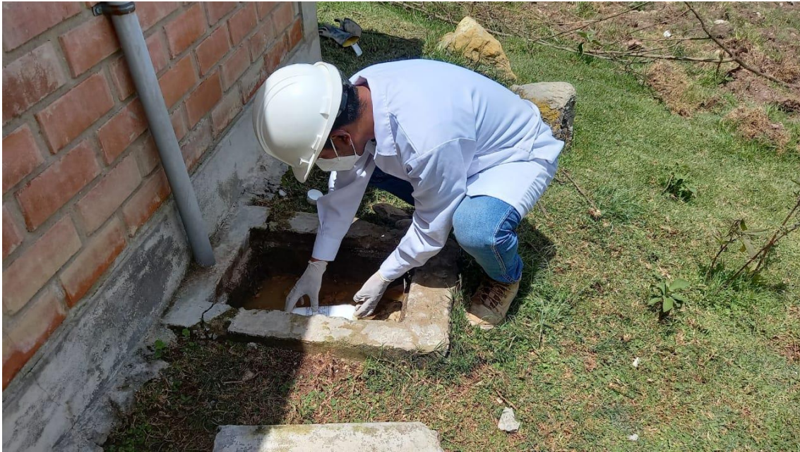
Figura 29. Toma de muestras para \text{DBO}_5 en el afluente del punto de monitoreo BP1.
