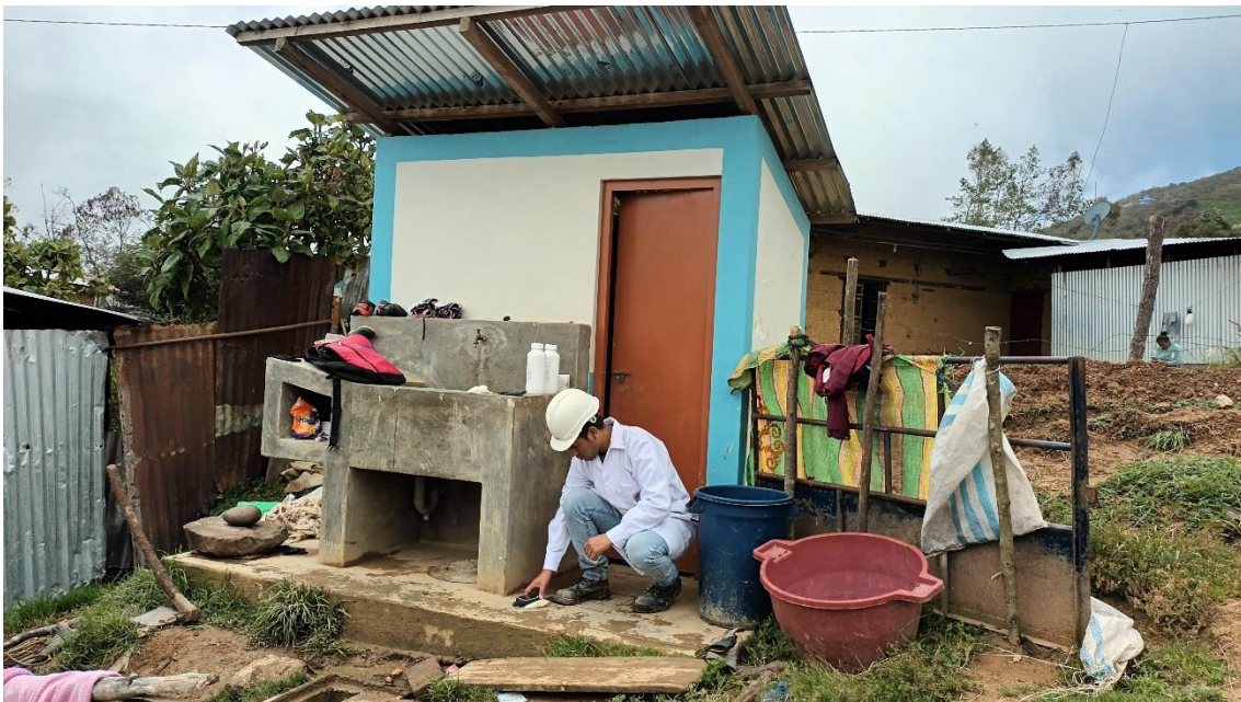
Figura 38. Verificación de la altitud con GPS Garmin para la toma de muestras en el afluente y efluente del punto de monitoreo BP6 a 3342 m.s.n.m.
