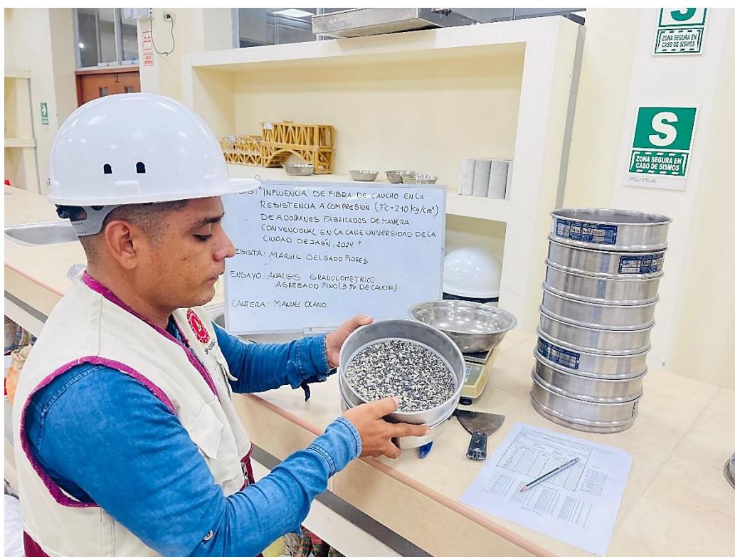
Figura 26. Ensayo granulometría agregado fino con proporciones de caucho.
