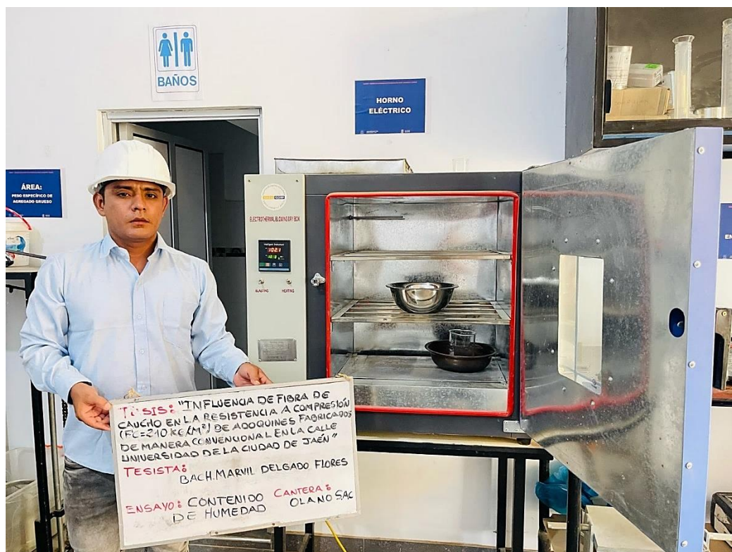
Figura 24. Ensayo de contenido de humedad.
