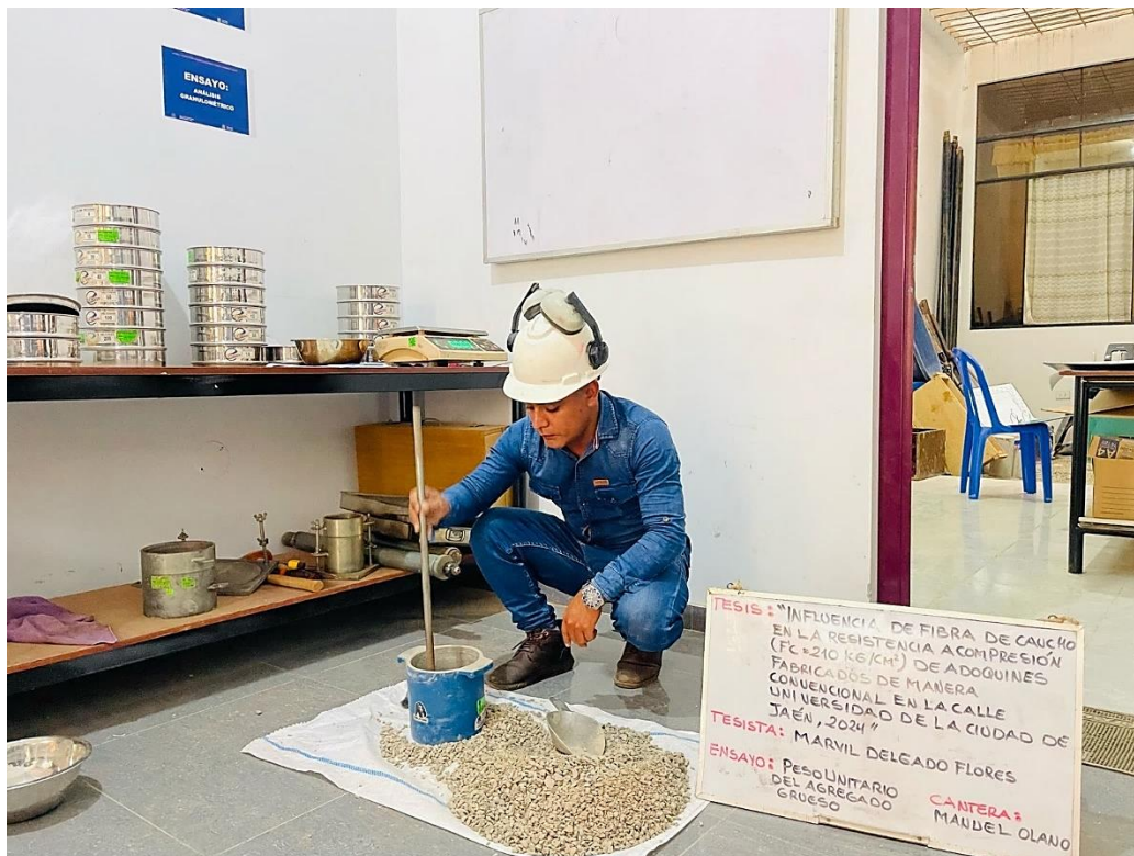
Figura 28. Peso unitario del agregado fino con proporciones de caucho.
