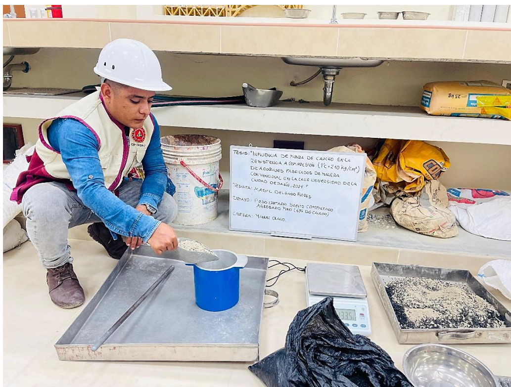
Figura 28. Peso unitario del agregado fino con proporciones de caucho.
