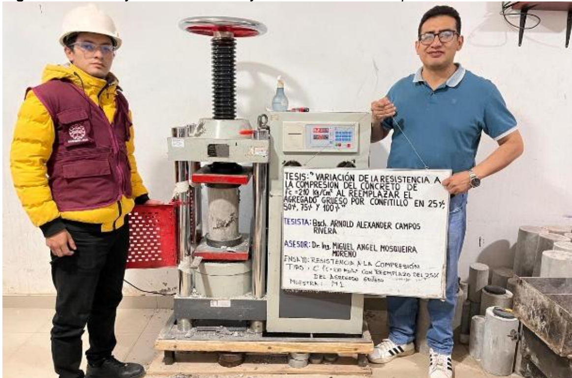
Figura 25: Tesista y asesor en el ensayo de resistencia a compresión
