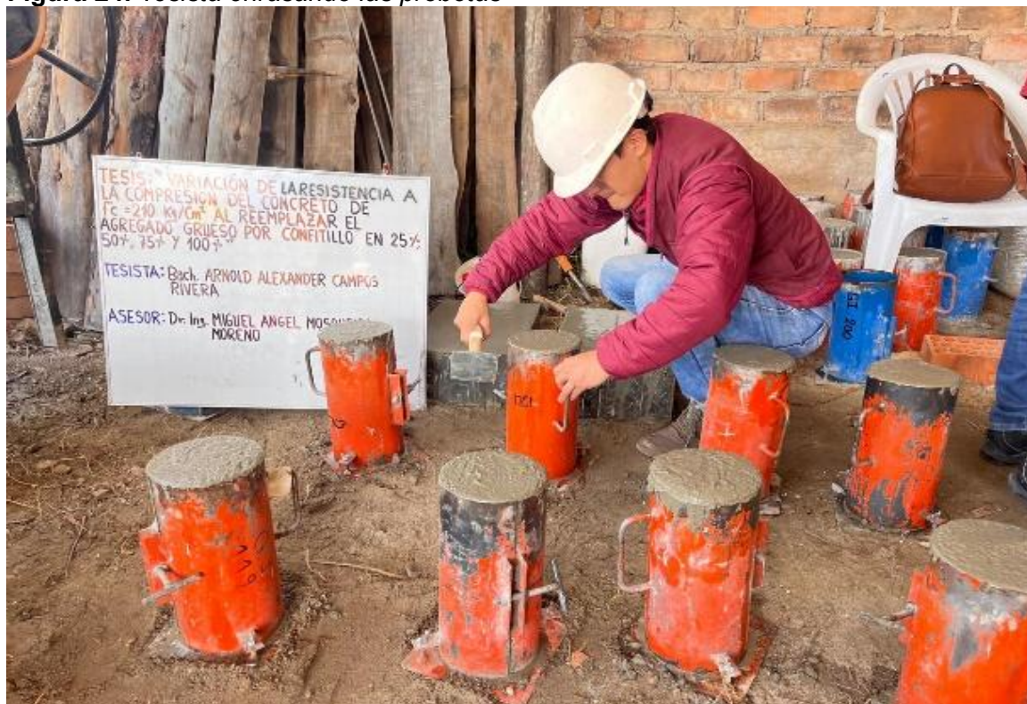
Figura 24: Tesista enrasando las probetas
