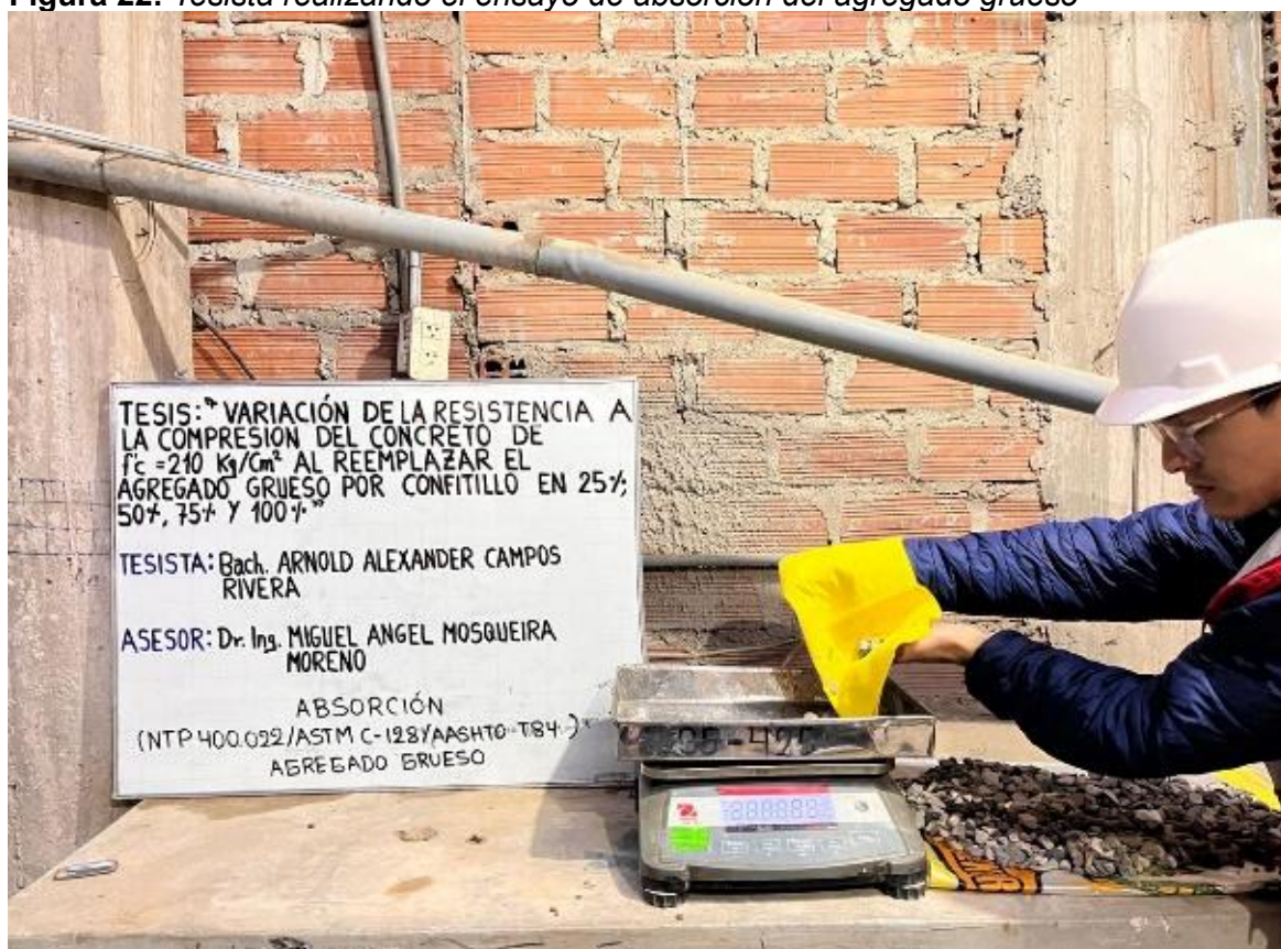
Figura 22: Tesista realizando el ensayo de absorción del agregado grueso
