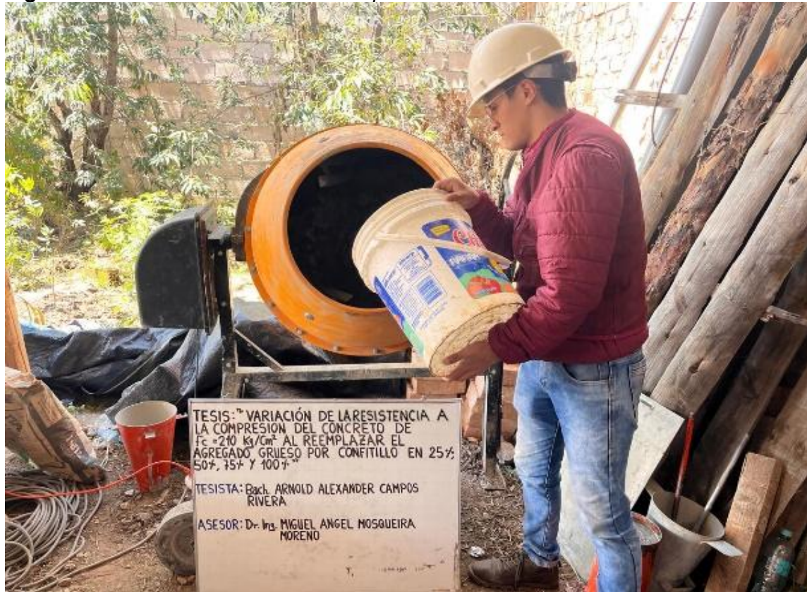
Figura 23: Tesista en la elaboración de probetas.
