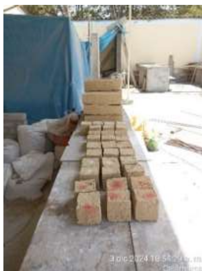
Figura 79. Especímenes de adobe 10x10x10
