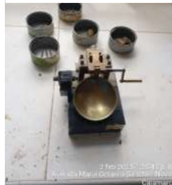
Figura 74. Ensayo límites de Atterberg
