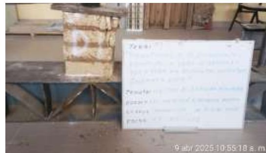
Figura 98. Murete de adobe ensayado
