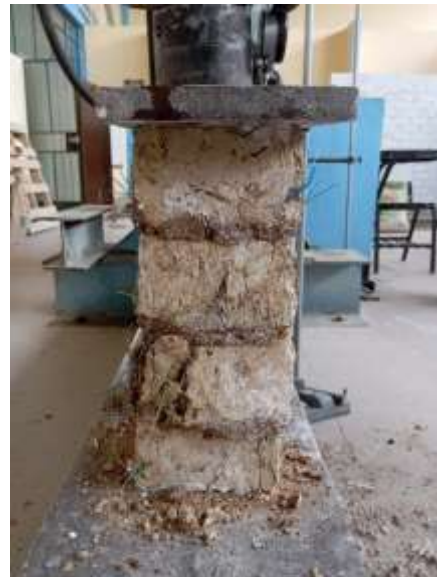
Figura 100. Rotura de murete con fibra de nylon
