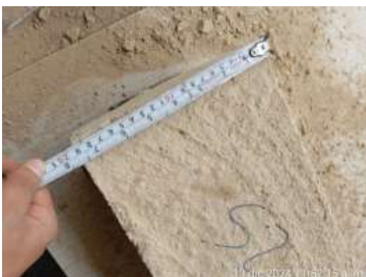
Figura 88. Toma de medidas adobe para flexión
