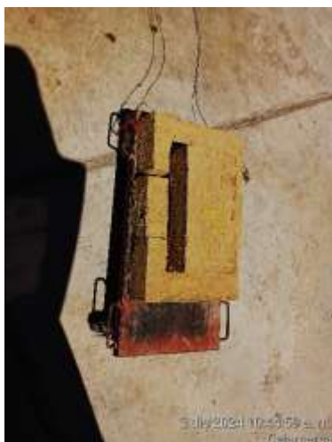
Figura 88. Toma de medidas adobe para flexión
