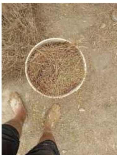
Figura 67. Preparación barro + Nylon
