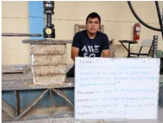
Figura 101. Rotura de murete sin fibra
