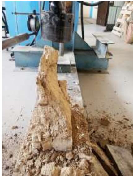
Figura 102. Rotura de murete con fibra de Ichu
