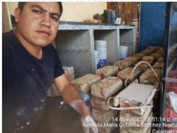
Figura 95. Muretes para compresión
