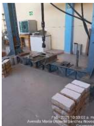
Figura 95. Muretes para compresión
