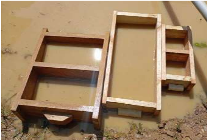
Figura 24. Preparación de barro
