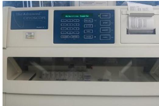
Segundo se colocó el casete en la casetera izquierda (entrada) con el número de identificación del casete orientado.
