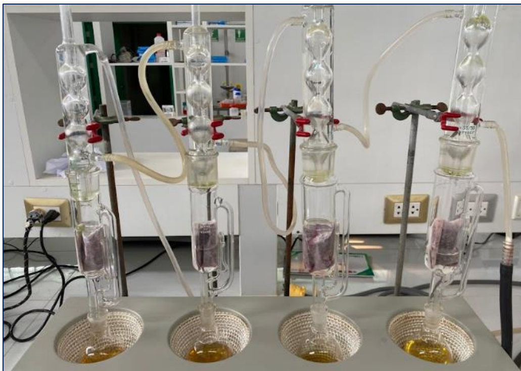
Sistema de extracción de aceite esenciales
