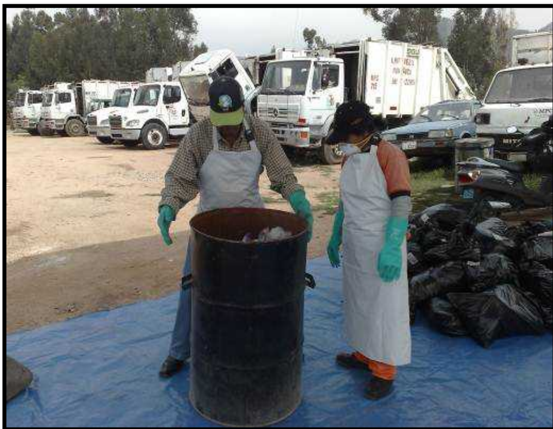
Fotografía 7 y 8. Cálculo de la densidad suelta y compactada de los residuos sólidos
